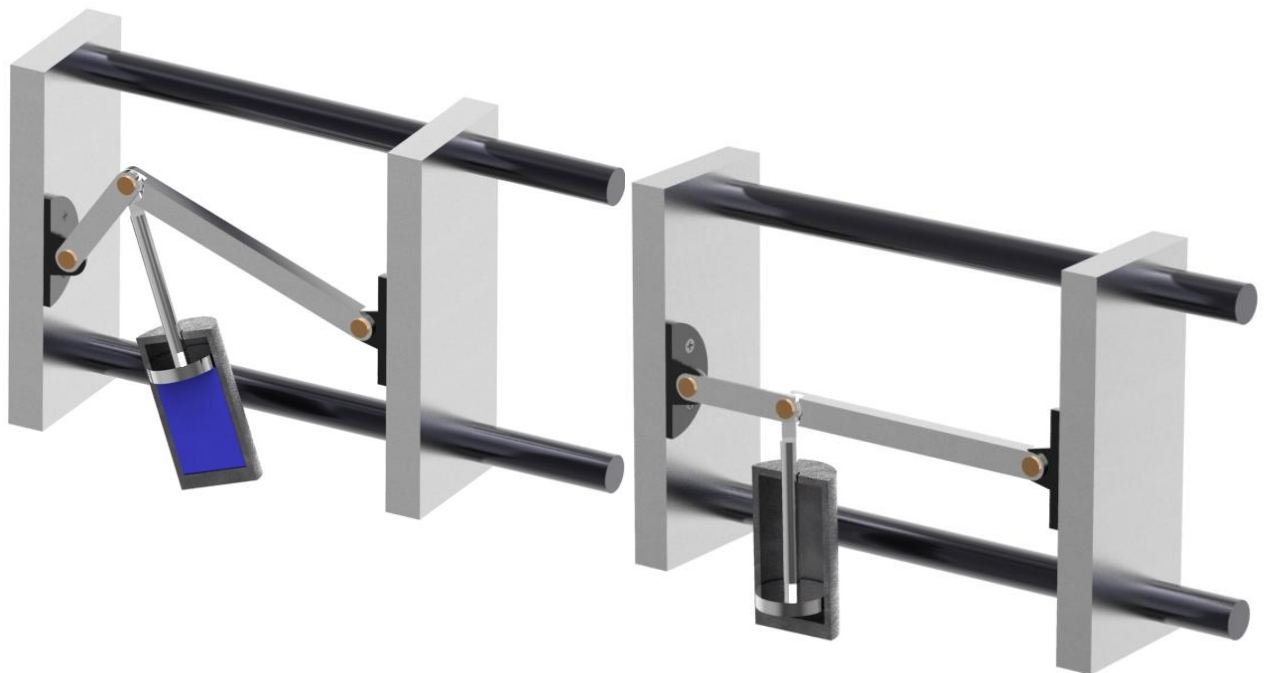
Obr. 18 – Princíp hydraulicko-mechanického uzatvárania formy [27]
