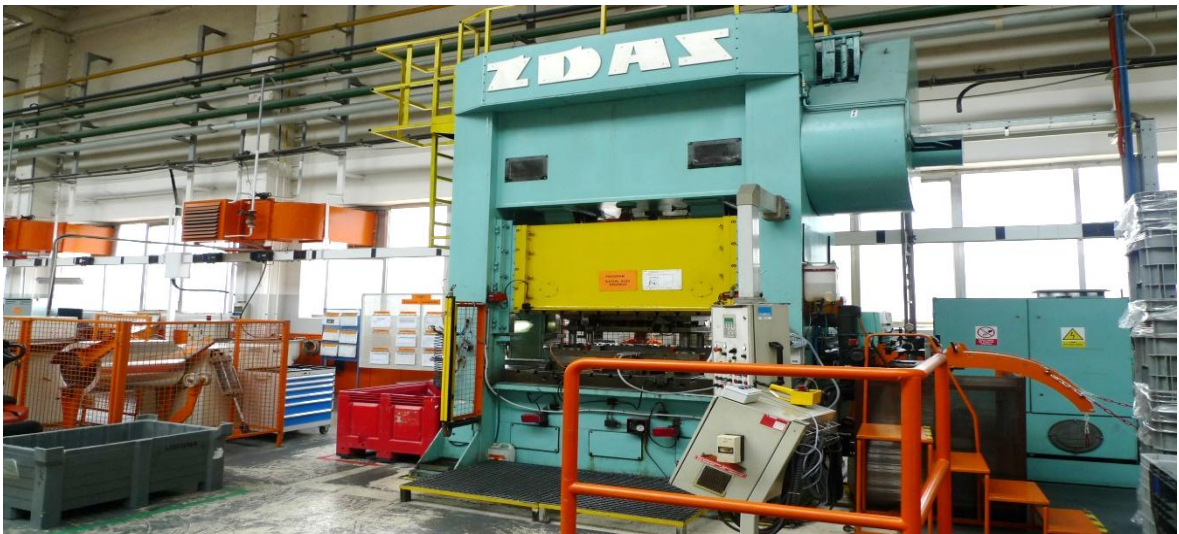
Obrázek 18: Výstředníkový lis 200t [21]
