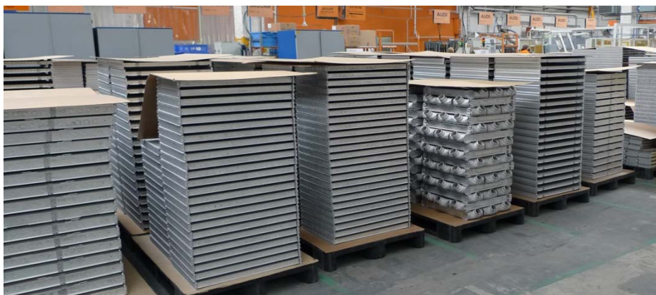
Obrázek 26: Zásoba vložek po operaci pájení [21]
