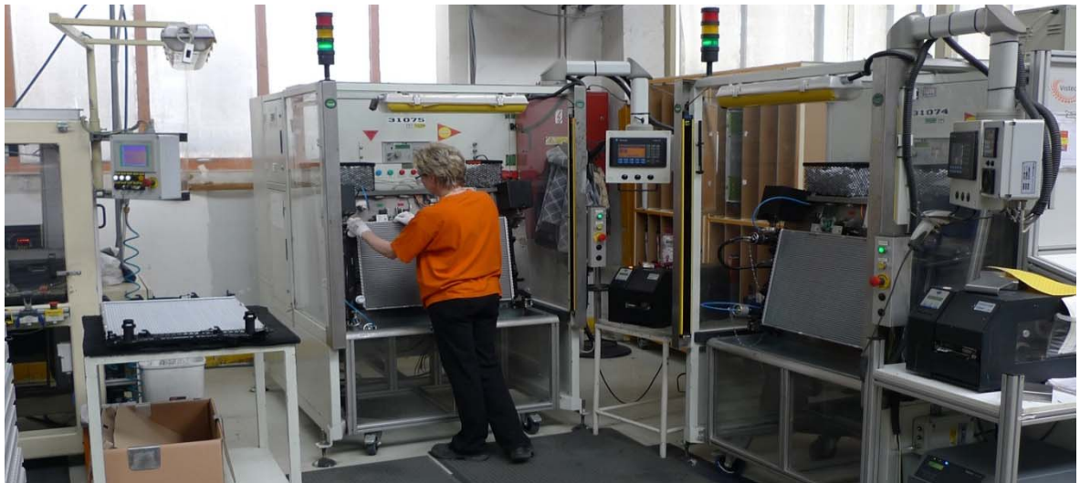
Obrázek 22: Uspořádání lemovací a testovací linky [21]
