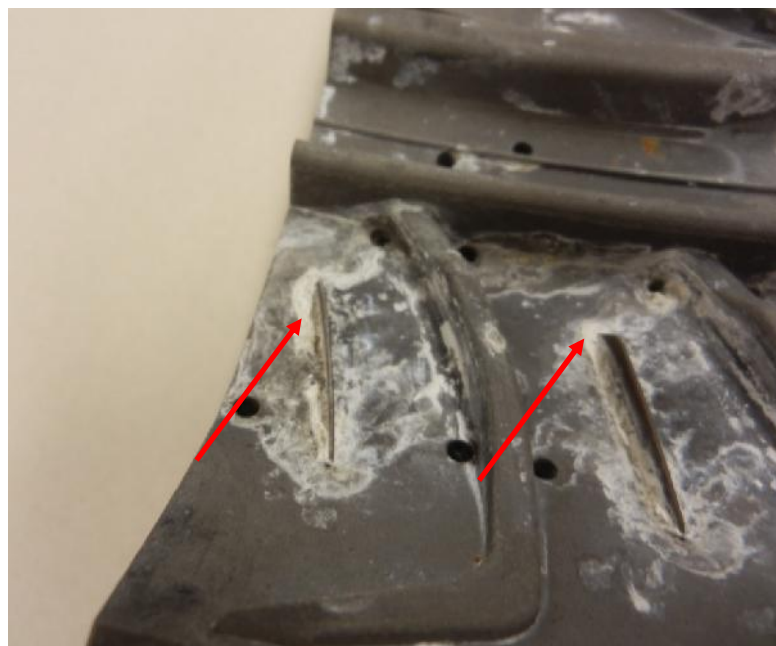
Obr. 33 AlSi 7 po 30 dnech korozního testování
