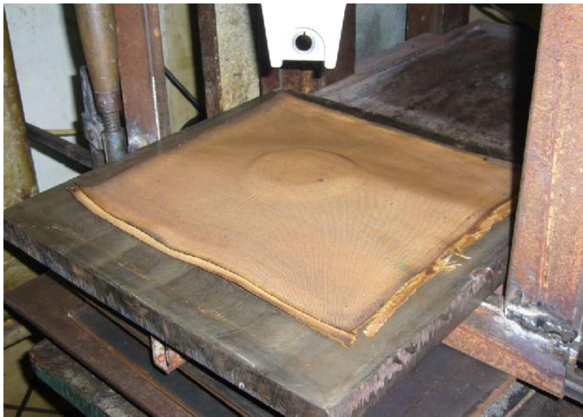
Obr. 26 Polotovar umíst ěný ve form ě a p ěkryt ě textil ě
