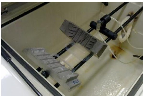
Obr. 31 Vnitřní prostor korozní komory LIEBISCH
