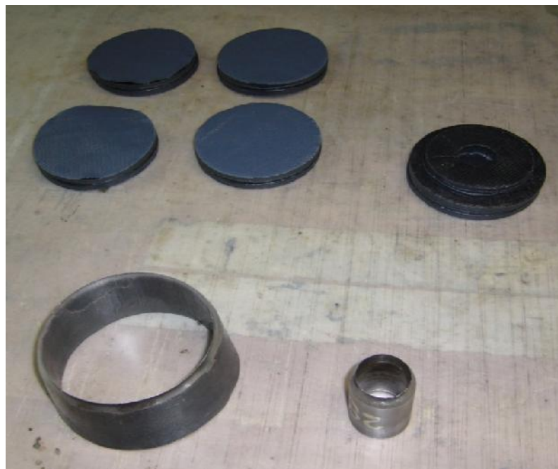
Obr. 22 Vyražené polotovary pomocí vysekávacích nož
