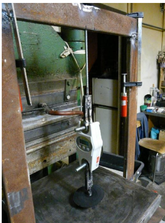
Obr. 28 M ěření síly k odtržení vylisku
