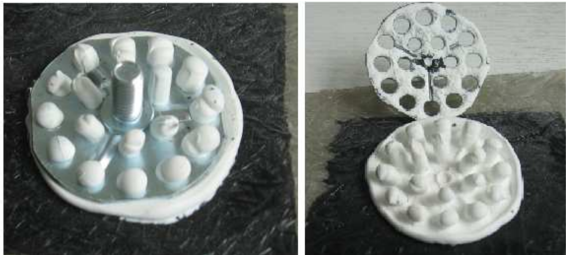
Obr. 48 Ukázka vzorku 1B+C před a po odtržení
