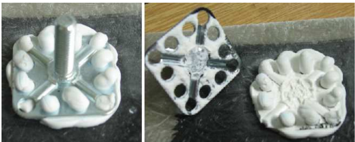
Obr. 52 Ukázka vzorku 3B+C před a po odtržení
