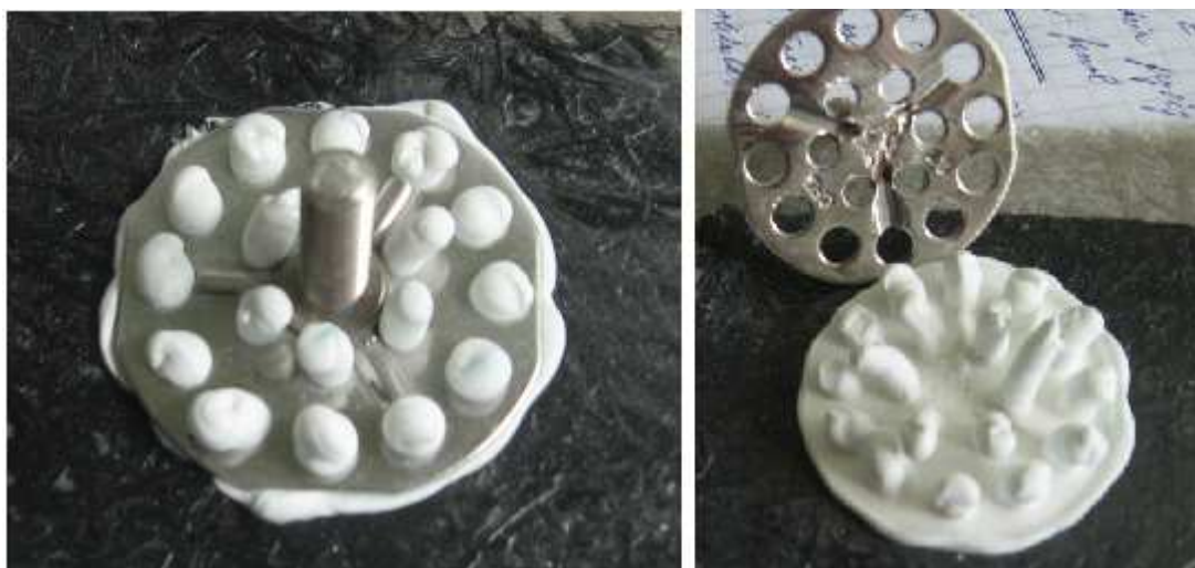
Obr. 49 Ukázka vzorku 2B před a po odtržení
