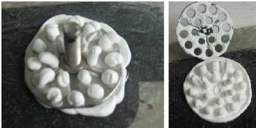
Obr. 50 Ukázka vzorku 2B+C před a po odtržení
