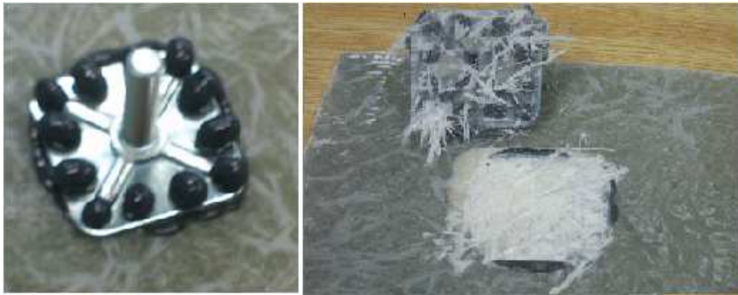
Obr. 45 Ukázka vzorku 3A před a po odtržení
