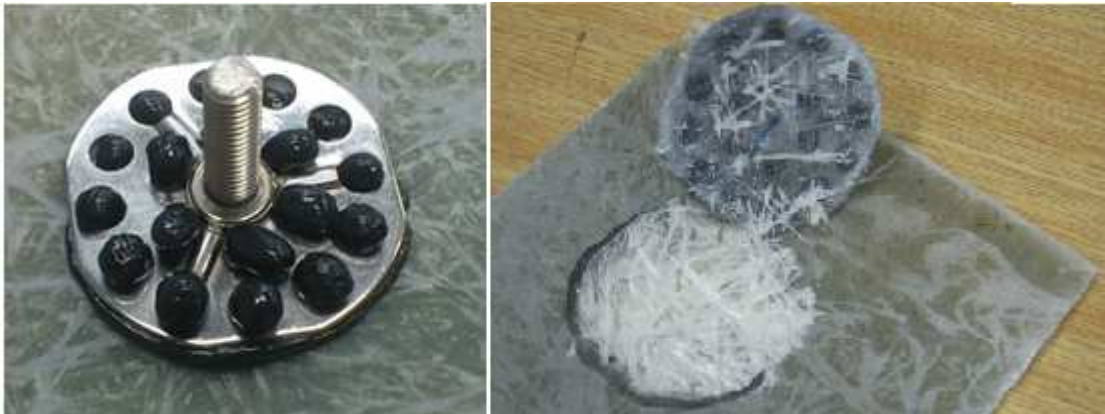
Obr. 44 Ukázka vzorku 2A před a po odtržení
