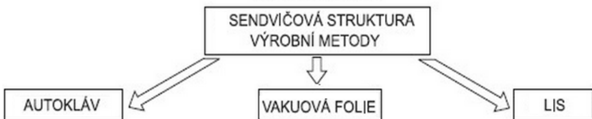
Obr. 18 Výrobní metody sendvičových kompozitních systémů. [13]
