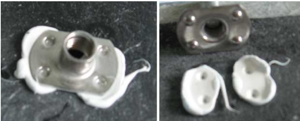
Obr. 53 Ukázka vzorku 5B před a po odtržení
