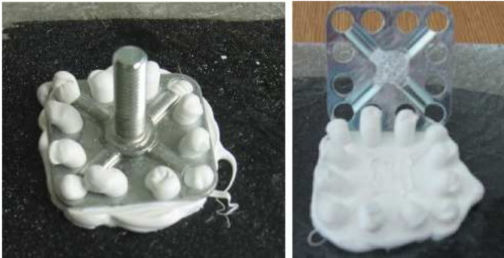
Obr. 51 Ukázka vzorku 3B před a po odtržení
