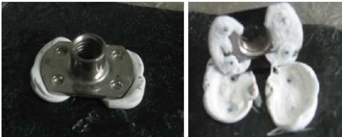
Obr. 54 Ukázka vzorku 5B+C před a po odtržení
