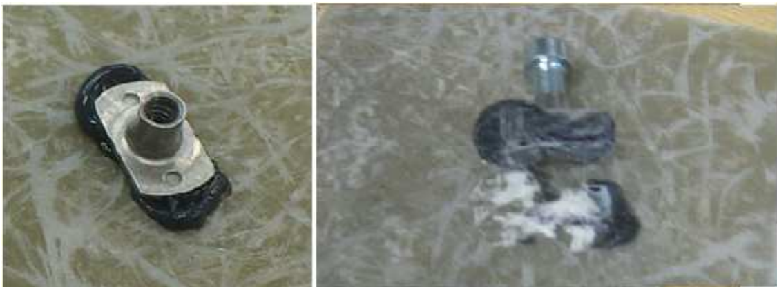
Obr. 46 Ukázka vzorku 4A před a po odtržení
