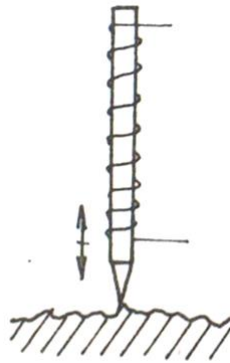
Obr. 10 Schéma elektroindukčného snímača [7]
