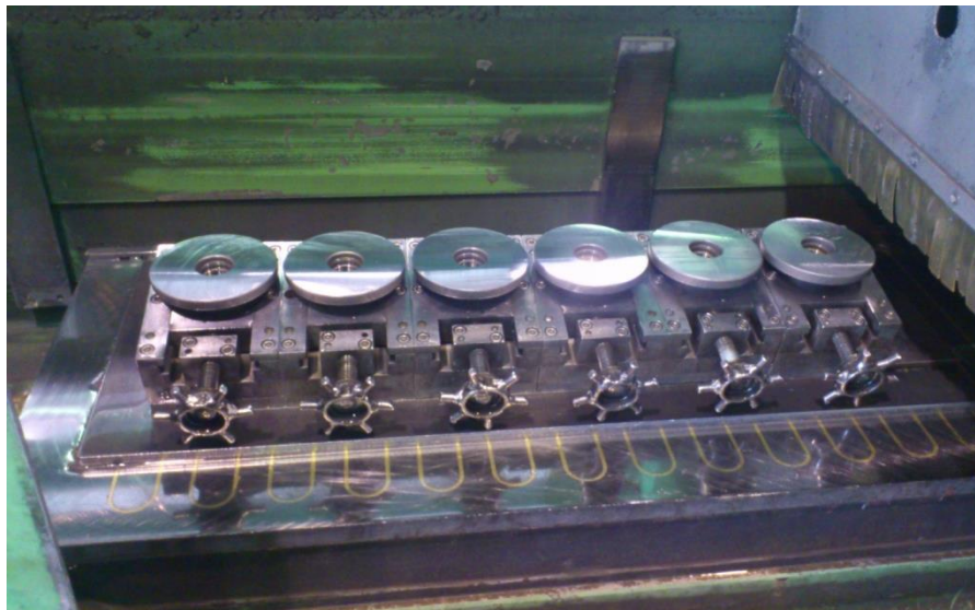
Obr. 17 Přípravok pre 1 obrobok, meradlo, 6 kusov prípravkov s upnutými obrobkami na pracovnom stole brúsky
