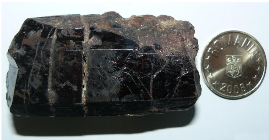
Obr. 18. Rutil – modifikace oxidu titaničitého [31]
