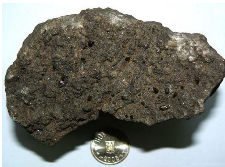
Obr. 19. Anatas – modifikace oxidu titaničitého [31]
