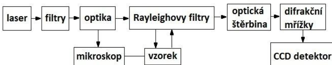
Obr. 9. Blokové schéma Ramanova spektrometru
