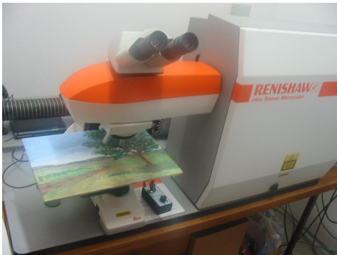
Obr. 50. Umístění vzorku (malba 01 – Olej) na motorický stolek
