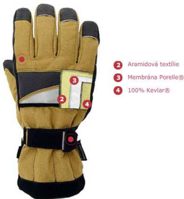
Obrázek 4: Řez rukavicí a ukázka složení sendviče [19]
