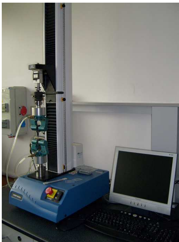
Obrázek 39: Trhací zařízení INSTRON typ 3345J8169 pro měření tahových zkoušek v laboratoři UFMI, FT, UTB ve Zlíně.
