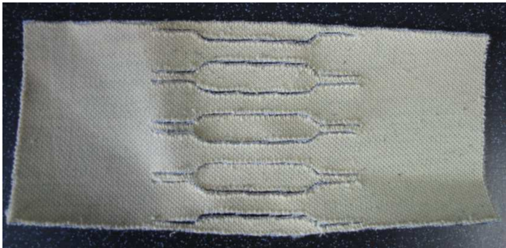
Obrázek 32: Obdélníkový výstřížek s vyřezanými lopatičkami pro mechanické testování o rozměrech 230x100 mm.
