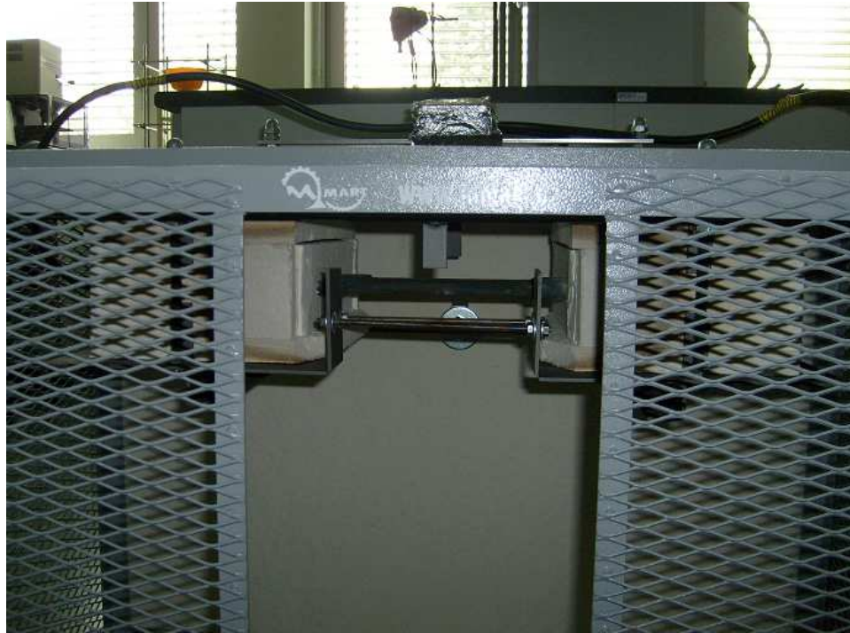
Obrázek 37: Silitové odporové tyče laboratorního tepelně degradačního zařízení HT 6942
