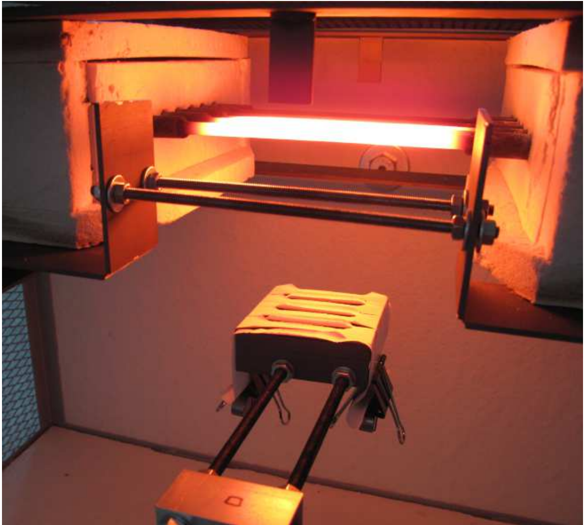
Obrázek 50: Proces degradace vzorku při plném výkonu silitových tyčí
