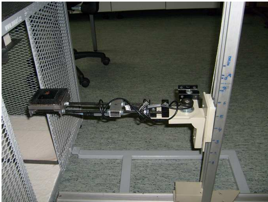
Obrázek 36: Kalorimetr a posuvný, výškově nastavitelný stojan pro vzorky k laboratornímu tepelně degradačnímu zařízení HT 6942 [47]
