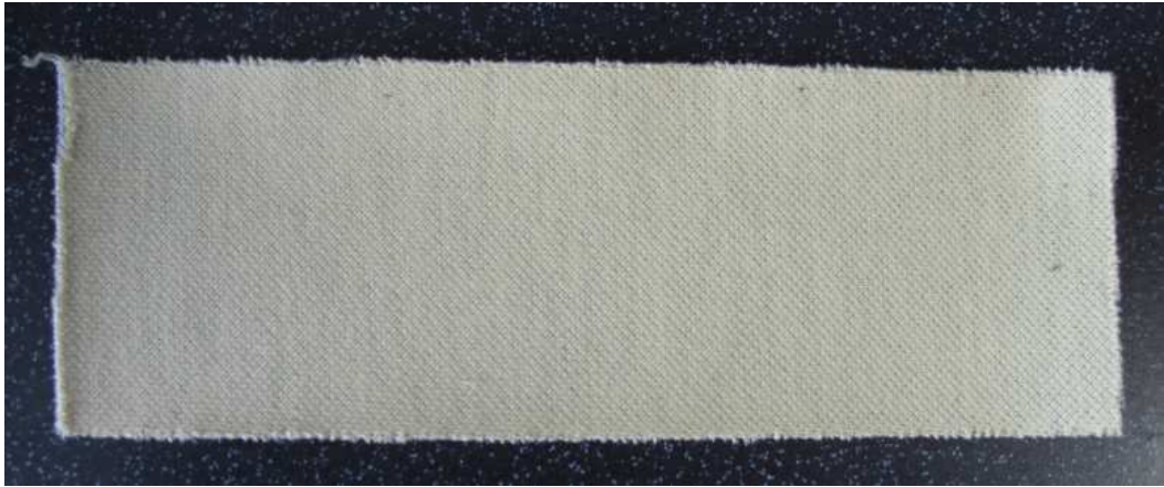
Obrázek 31: Obdélníkový výstřížek pro testování o rozměrech 230x80 mm.
