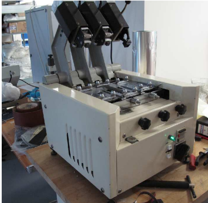
Obrázek 46: Testovací stroj pro simulování změny struktury povrchu při oděru a otěru
