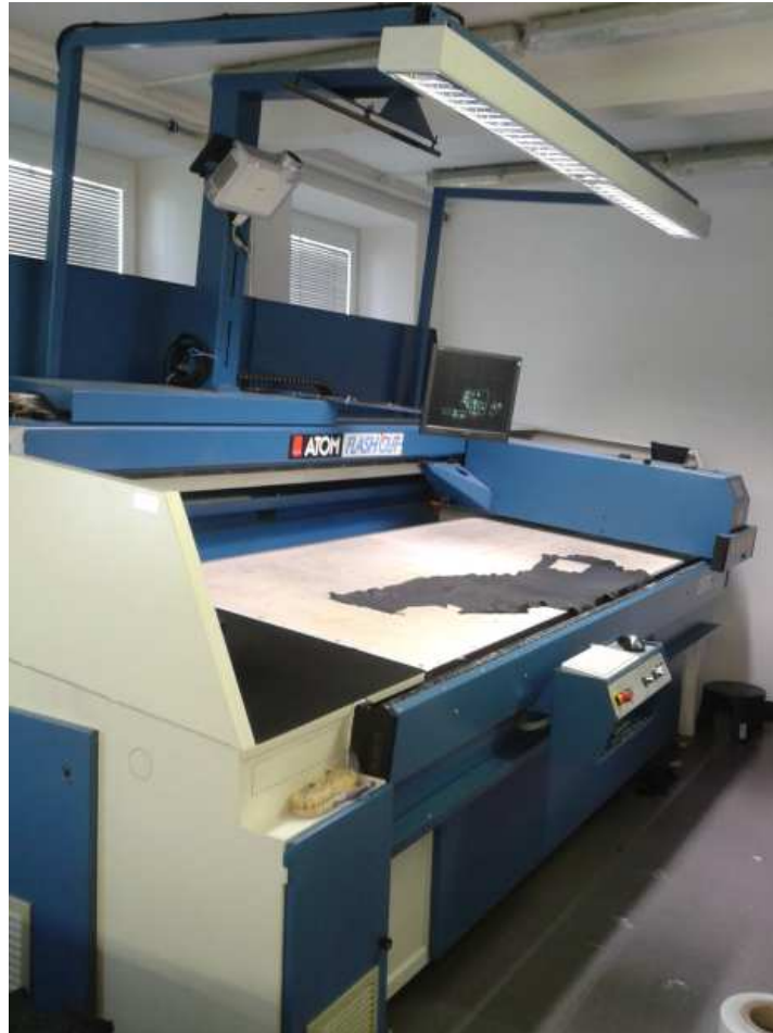
Obrázek 30: Oscilační vyřezávací plotr ATOM FlashCut, použitý pro přípravu vzorků.
