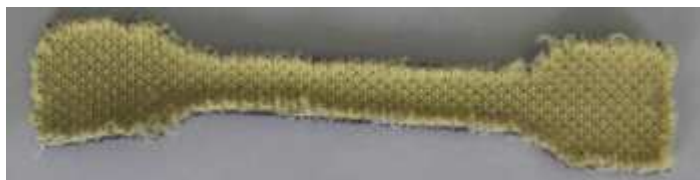
Obrázek 33: Lopatička pro mechanické testování o šířce 10 mm (zúžená část) a 20 mm (rozšířená část).
