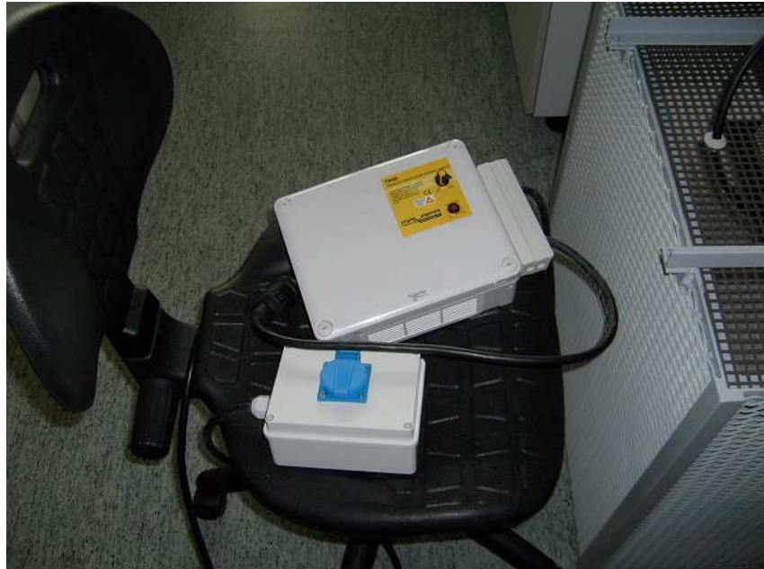
Obrázek 35: Regulátor výkonu pro laboratorní tepelně degradační zařízení HT 6942 [47]
