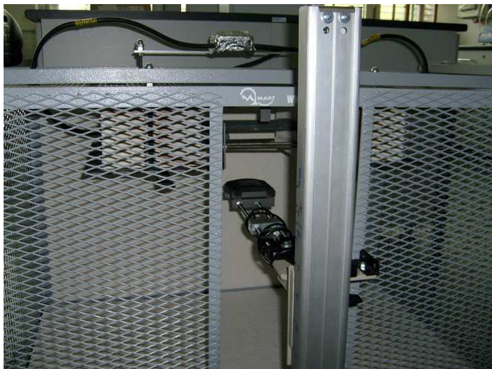
Obrázek 38: Pozice kalorimetru umístěného v laboratorním tepelně degradačním zařízení
