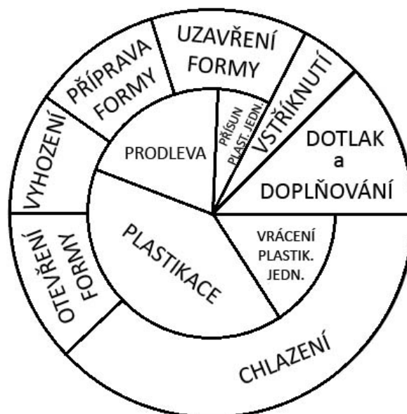
Obr. 1. Průběh vstřikovacího cyklu [4]
