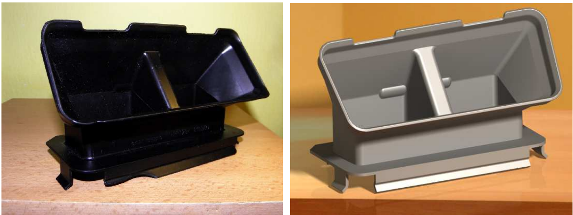
Obr. 16. Předloha (vlevo) a 3D model výrobku
