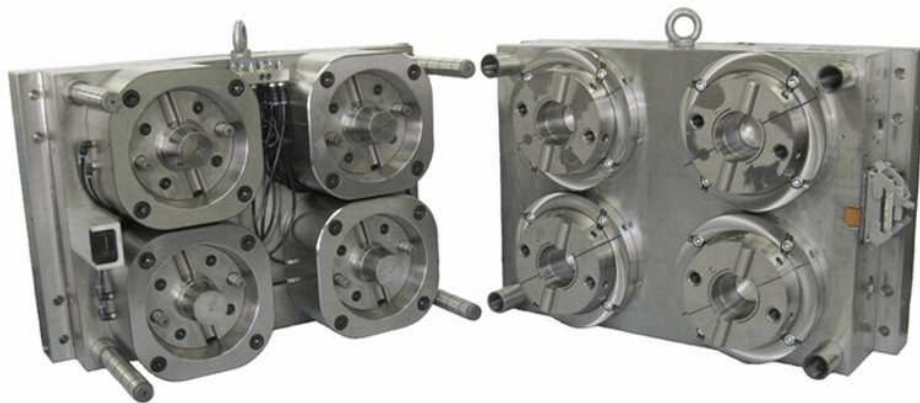
Obr. 7. Pohled do otevřené vstřikovací formy [6]
