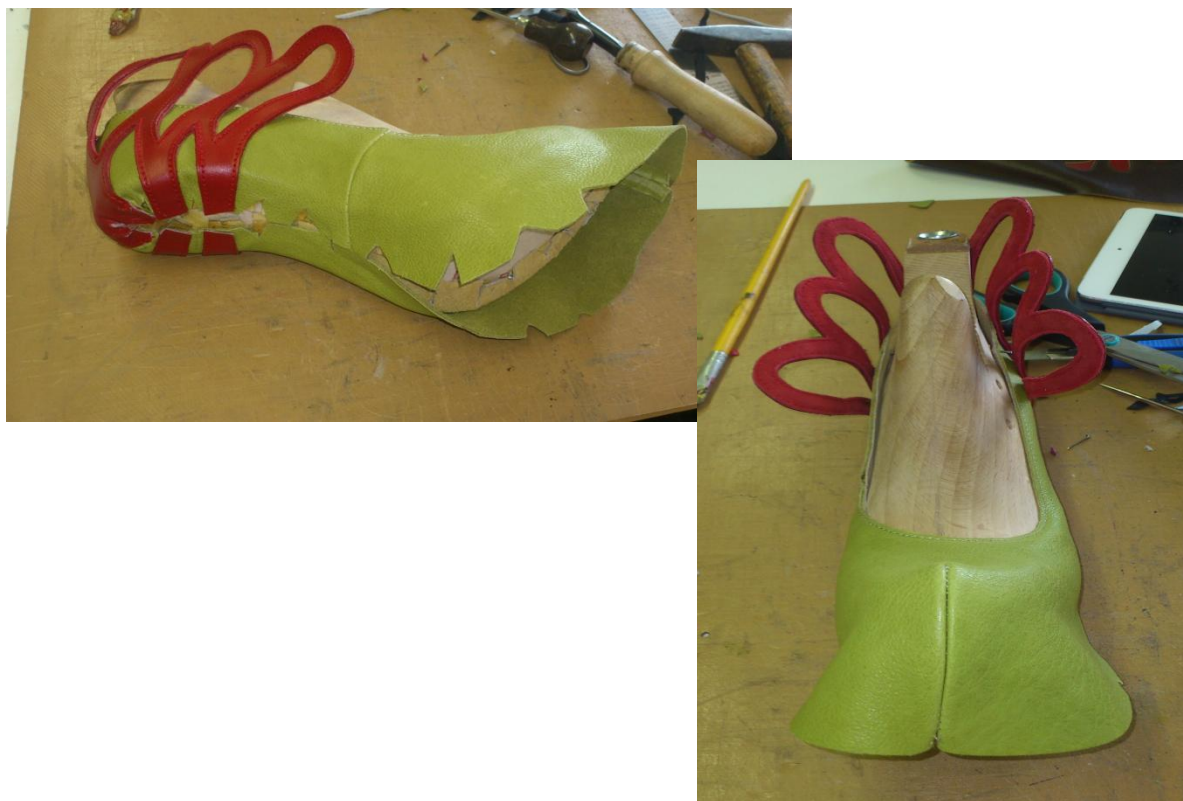
Obrázok č. 48, 49 Napínanie zvršku na kopyto
