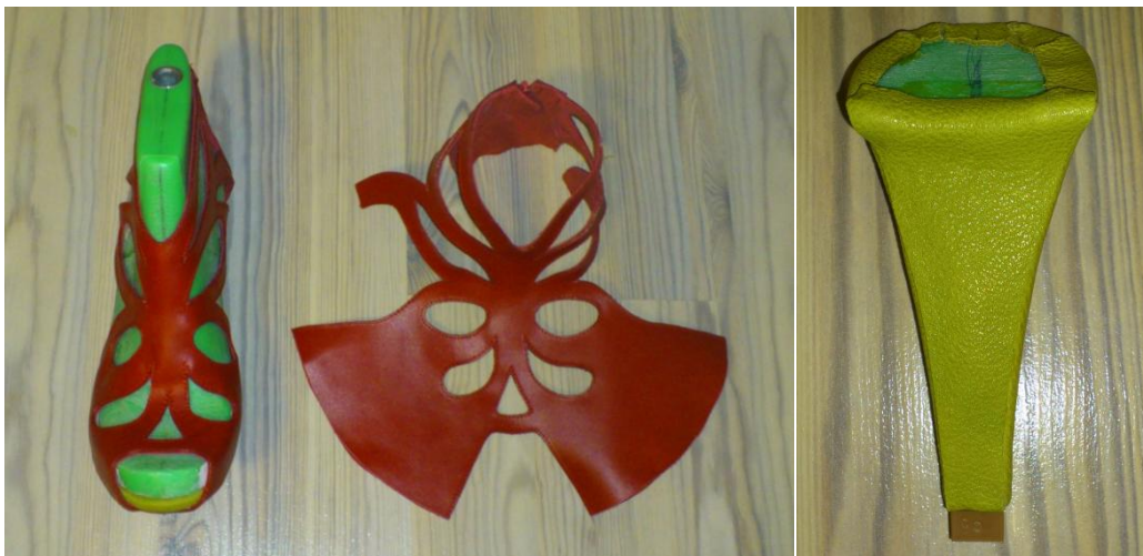
Obrázok 65 Napínanie zvršku modelu č. 2
