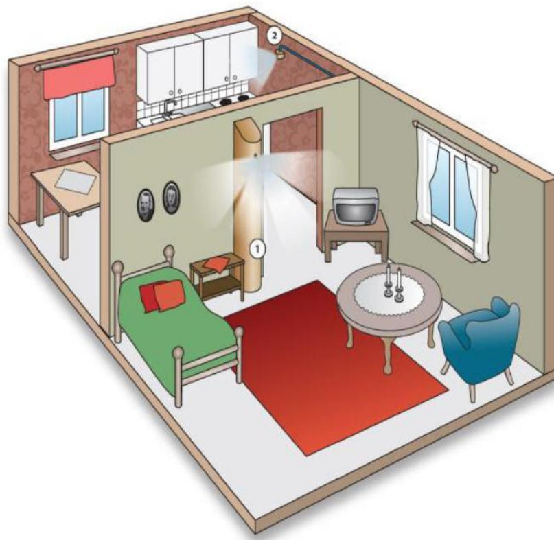
Obr. 19 Domácí mobilní mlhové zařízení Q1 [17]
