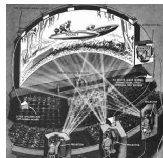
Obrázok 11: Formát obrazu Cinerama a spôsob premietania
