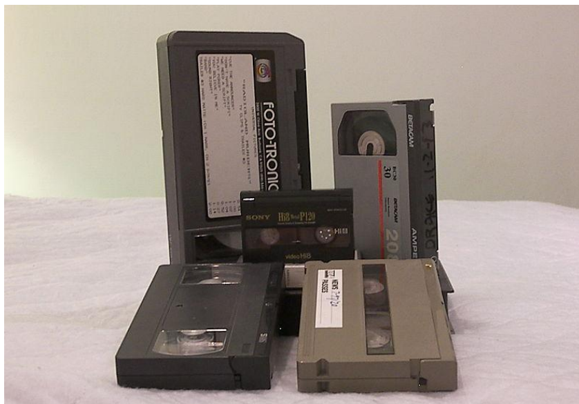
Obrázok 18: Porovnanie veľkostí kaziet: najväčšia U-matic, vzadu Betacam, v strede Hi8, vpredu vľavo VHS a vpravo M-II
