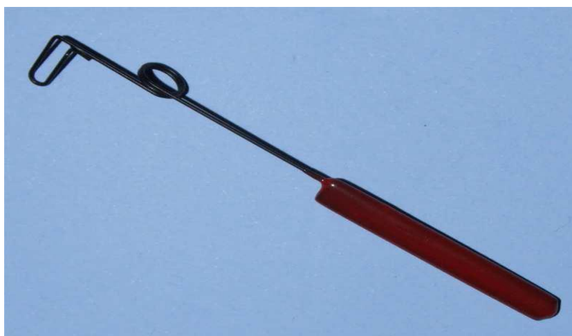
Obr. 14. Pružinový napínák (Feather touch tension wrench) 6
