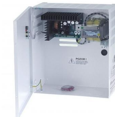
Obrázek 17 – Záložní napájecí zdroj KPN-18/90SAHW [37]
