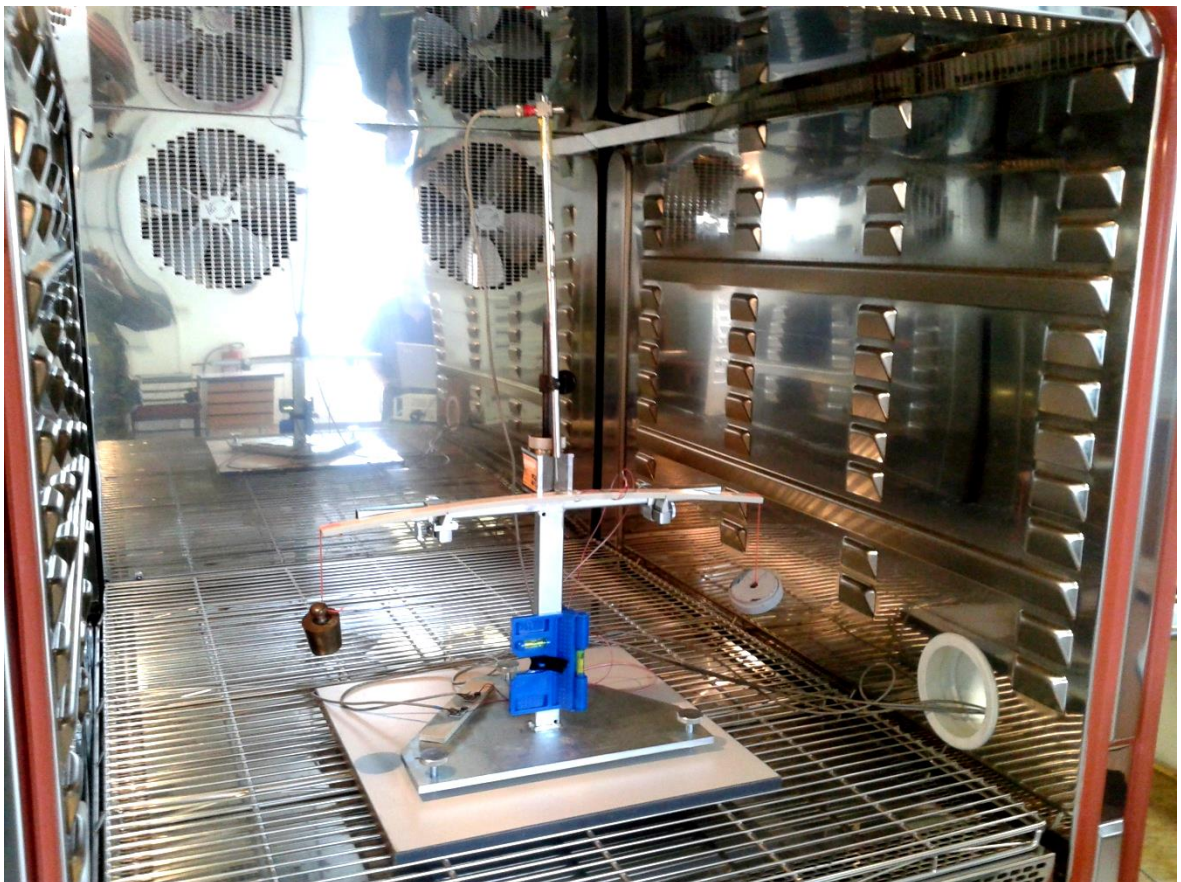
Obr. 43. Přípravek se zatíženým nosníkem v klimatické komoře.
