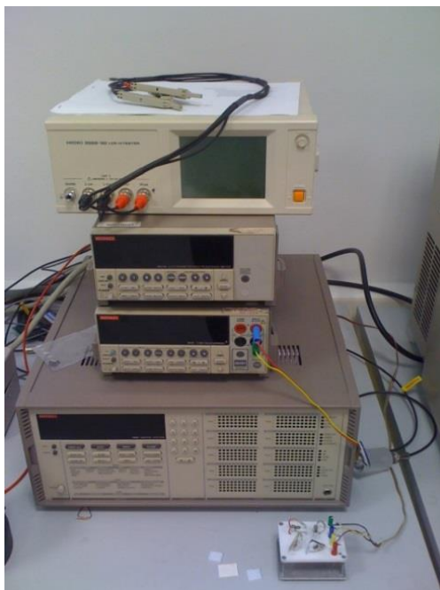
Obr. č. 17: Soustava pro měření rezistivity metodou van der Pauw.
