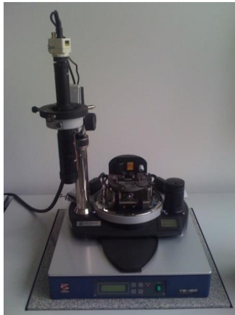
Obr. č. 18: Mikroskop atomárních sil NT-MDT NTEGRA-Prima.
