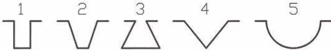
Obr. 3. Základní typy nerovností lepených ploch. [10]
