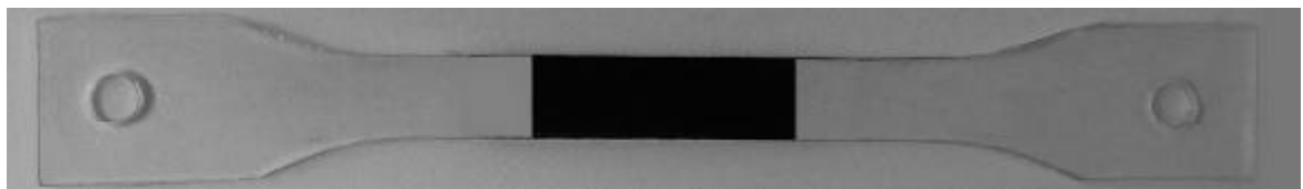
Obrázek 15 – oboustranná lopatička s MWCNT senzoričnou vrstvou
