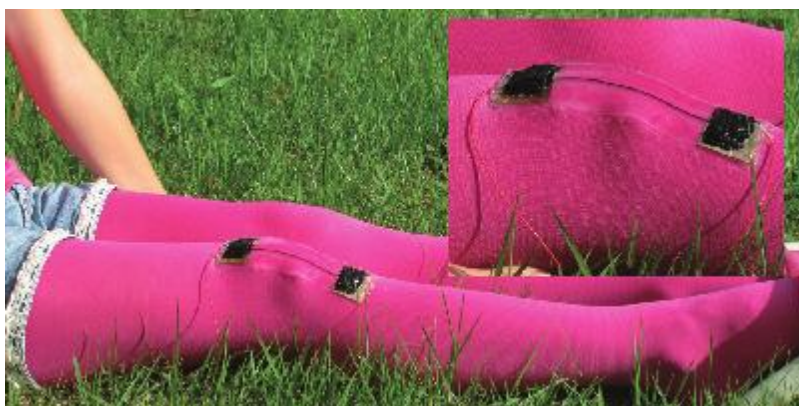
Obrázek 11 – upevnění tenzometrického senzoru na koleni
