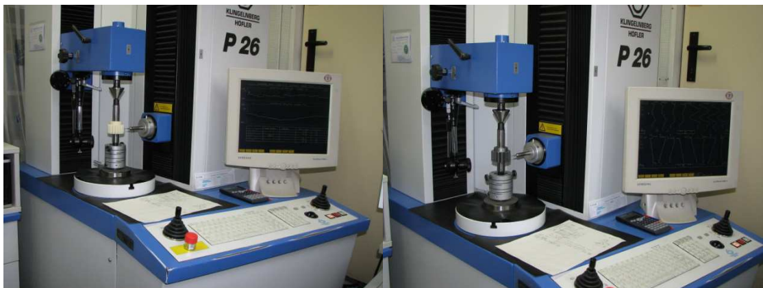
Obr. 49. Proměření přesnosti ozubení u malého kola – pastorku
