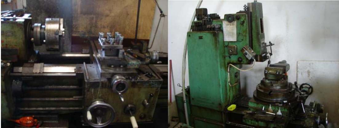
Obr. 36. Na levé fotce hrotový soustruh SU40, na pravé obrážecí stroj 7A 412
