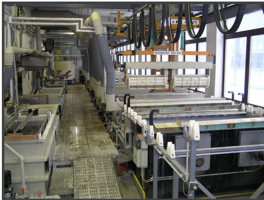
Obr. 6 Kompletní automatizovaná galvanická linka na hromadné pokovování
