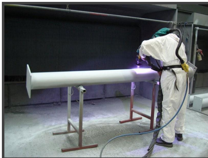
Obr. 3 Nanášení ochranné vrstvi pomocí metalizace
