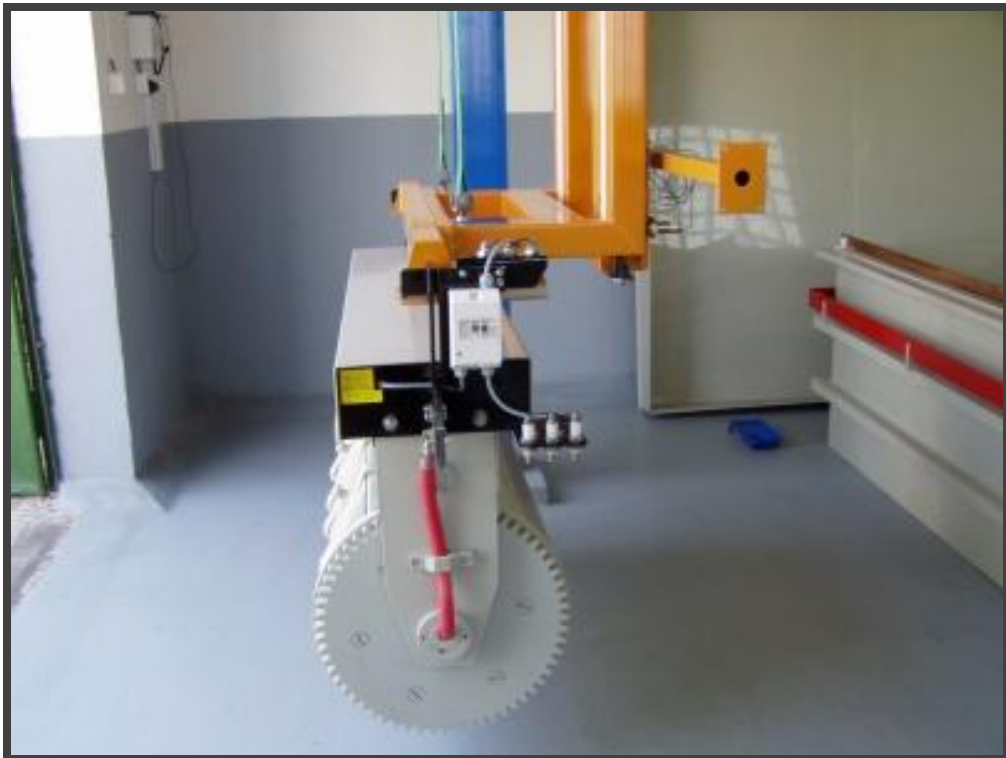
Obr. 26 Řešení galvanické jednotky pro hromadné pokovování od firmy J.V.Š. Jednoduchá střecha jednotky, bez krytu proudových rozvodů, ale velmi dobré a oblíbené řešení přídržovače katod
