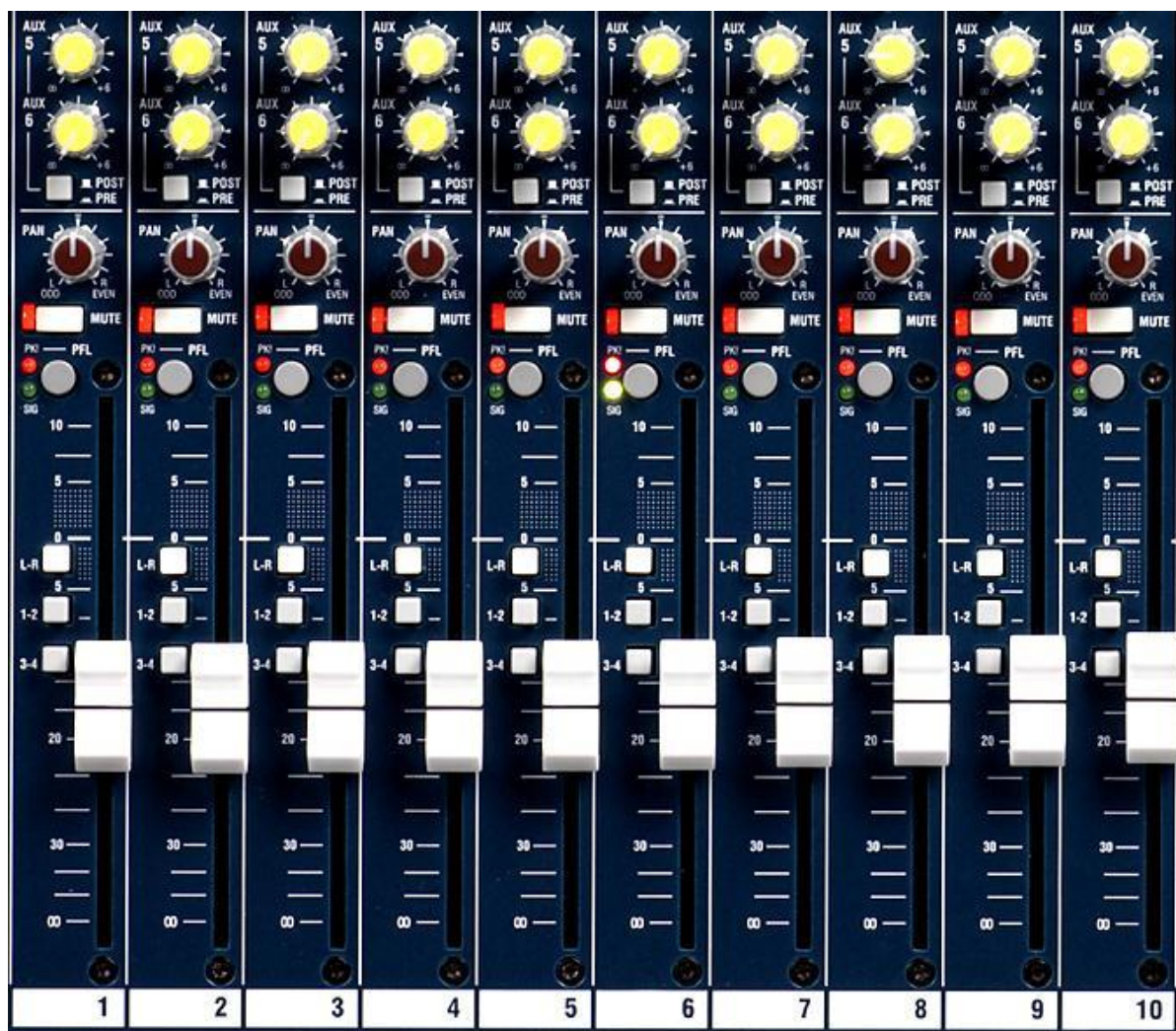
(obr. 18 – výřez části mixážního pultu s fadery, group tlačítka L-R, 1-2, 2-4, potenciometrem panoramy (PAN) a potenciometry AUX)
