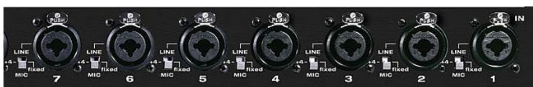
(obr. 11 - vstupní část zvukové karty motu896 s přepínačem vstupní úrovně mezi: line a mic)
