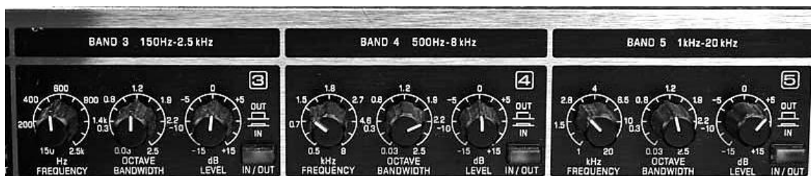
(obr. 12 – Výřez tří pásem samostatné jednotky parametrického ekvalizéru do 19“ racku)
