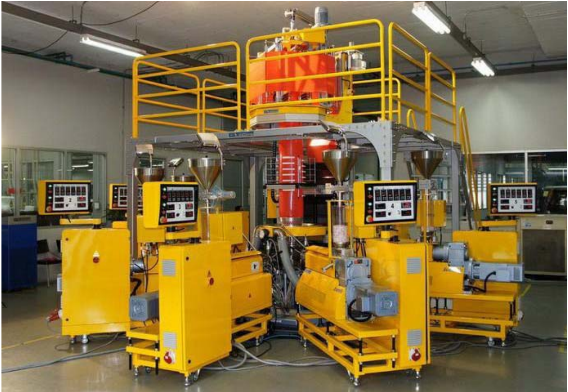
Obr. 14 Koextruzní vytlačovací linka na pětivrstvé fólie [52]
