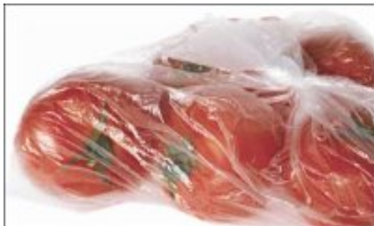
Obr. 5 Biofólie vyrobená z kyseliny mléčné a polyhydroxybutyrátu [26]
