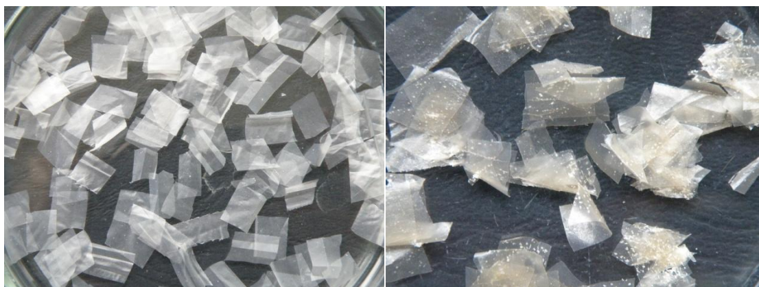
Obr. 11: Folie Ecoflexu s plnivem na začátku testu a po ukončení testu
