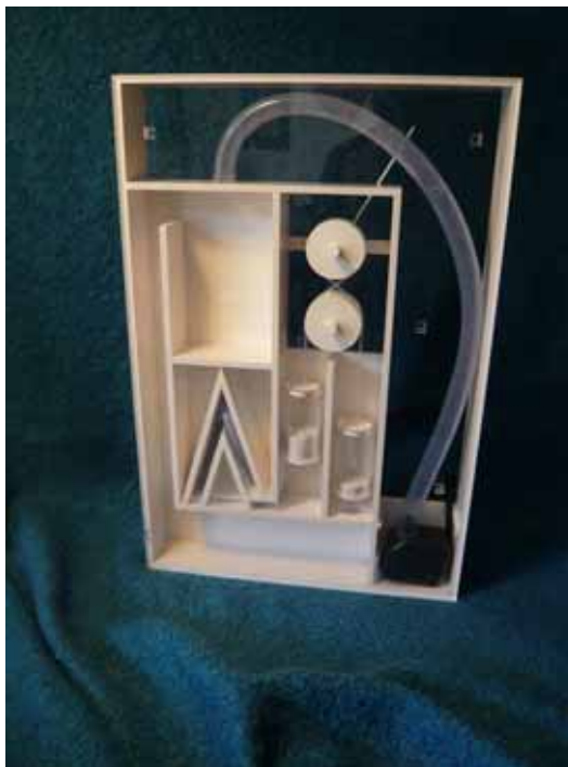
Obr. 89 Klepsydra: produkt, tělo hodin doplněné o čelní desku a volné komponenty, model 2.0
