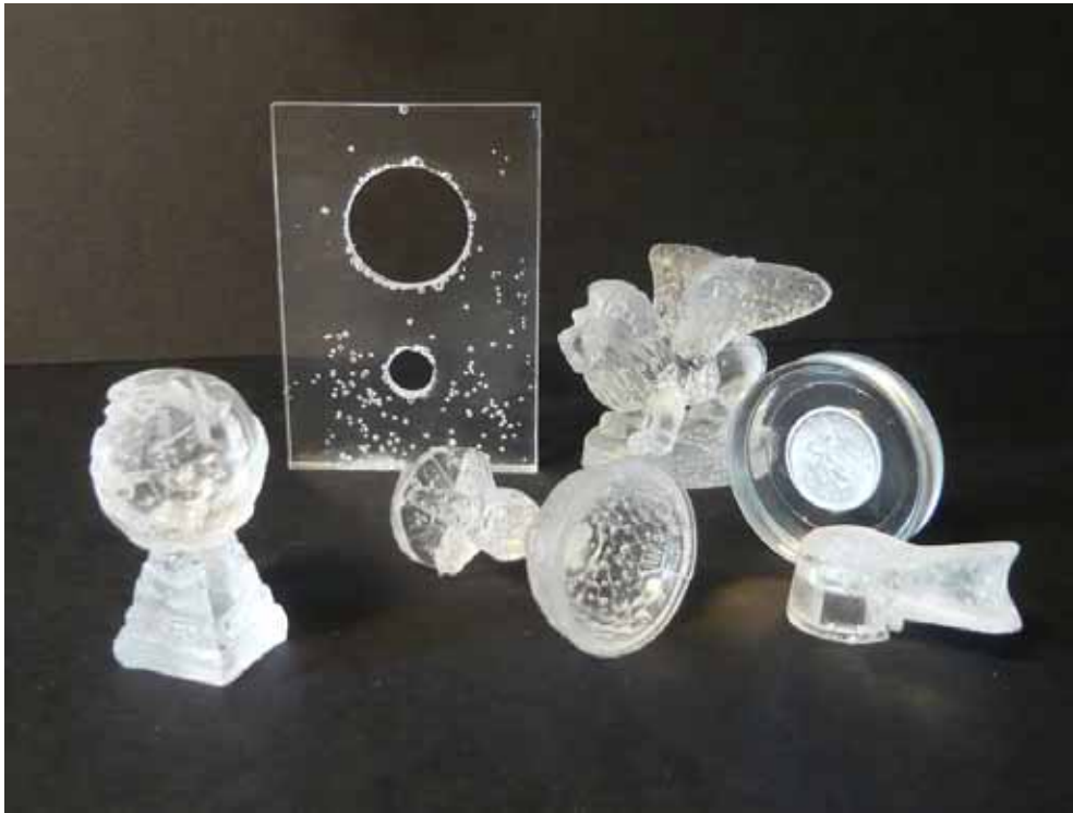
Obr. 81 Klepsydra: produkt, odlitky z CER čiré epoxidové pryskyřice v domácím prostředí
