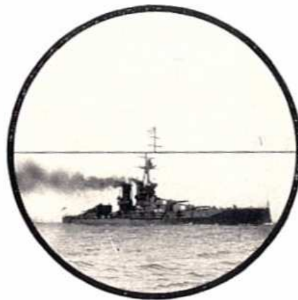
Obr. 34: Společné zorné pole před seřízením [25]
