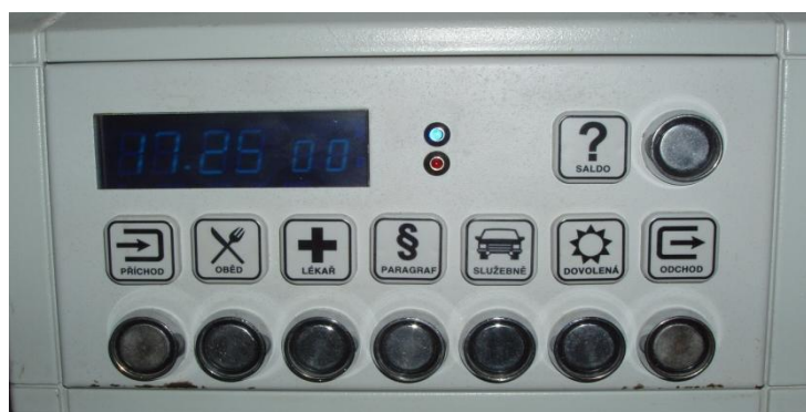
Obr. 17 Panel docházkového terminálu
