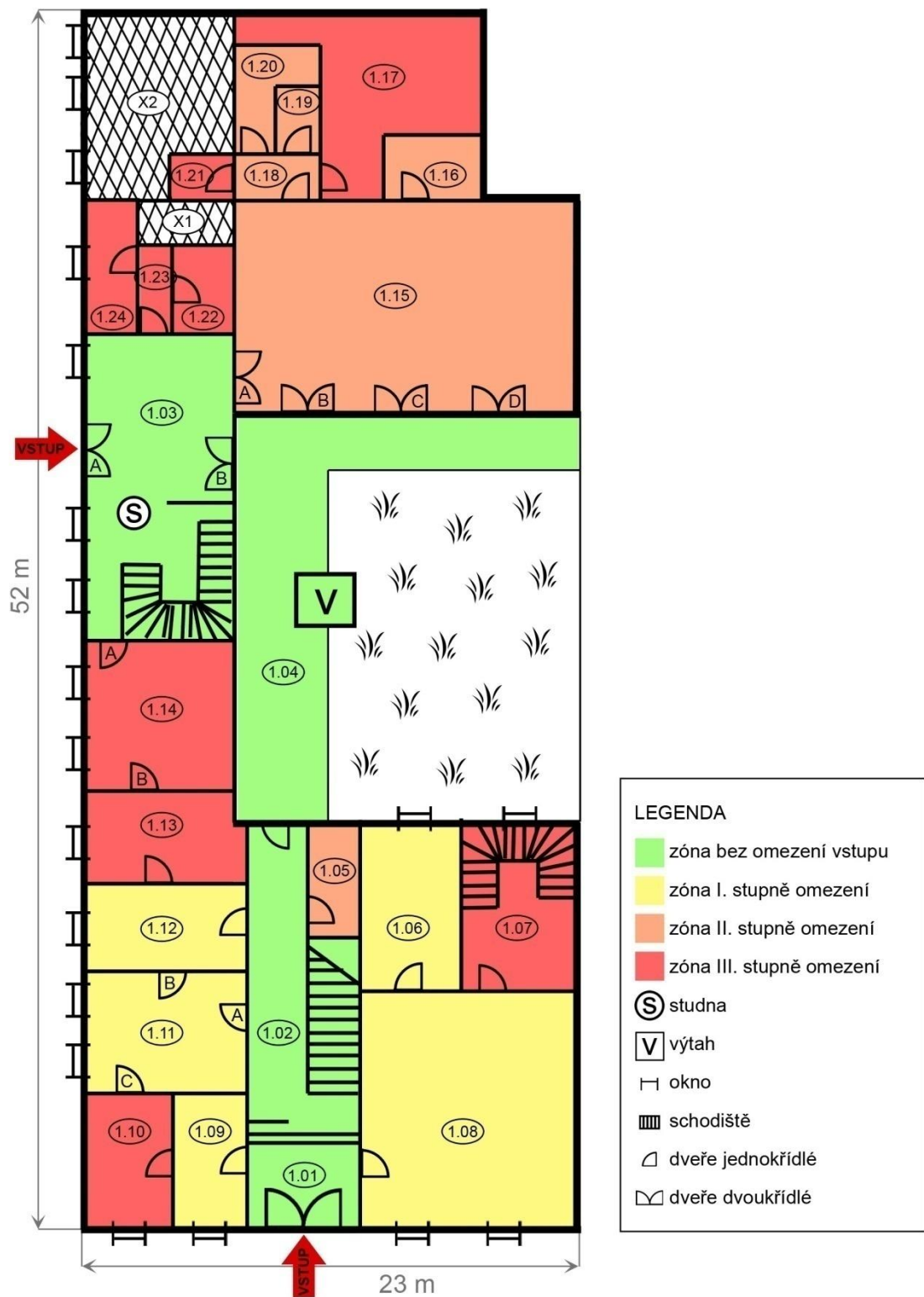
Obr. 20 Půdorys 1. nadzemního podlaží
