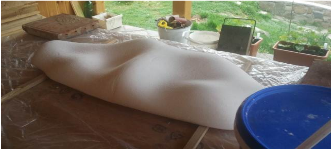
Obrázek 85. Nanesení sádrové stěrky na polystyrenový model.
