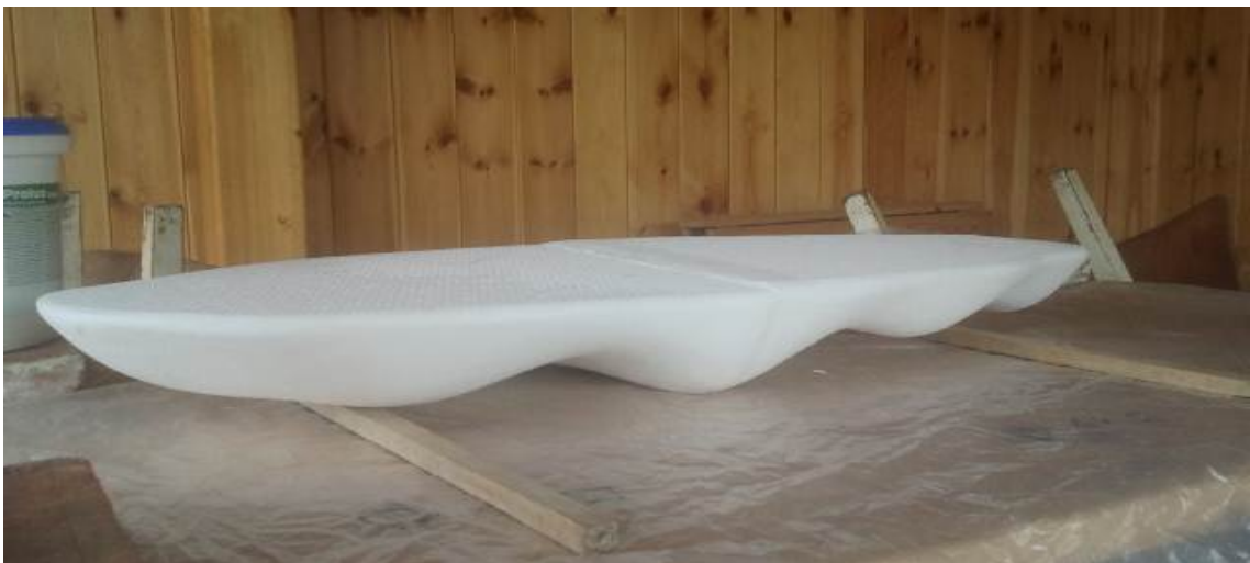
Obrázek 86. Model po slepení a částečném broušení.
