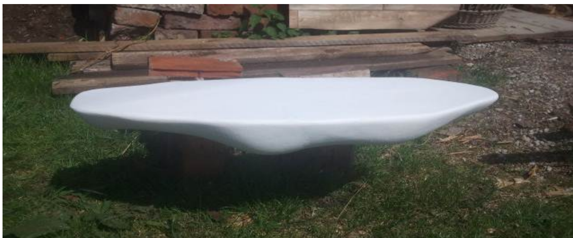
Obrázek 88. Vybroušený model před nastříkáním akrylové barvy.
