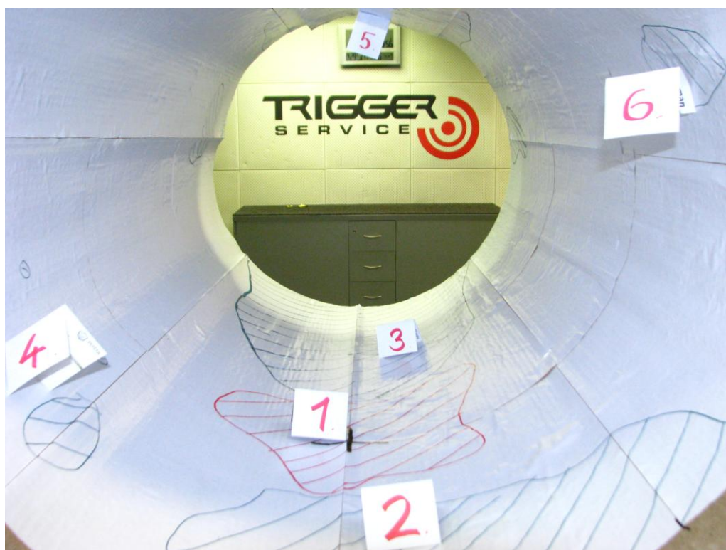
Obr. 35 Příklad sestavených povýstřelových map ve válci
