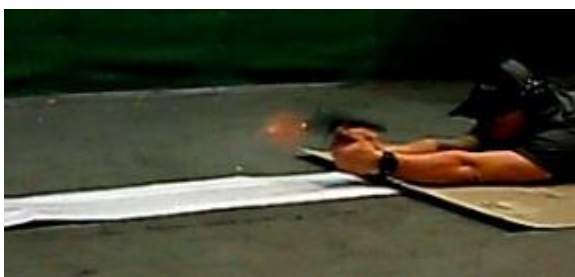
Obr. 34 Střelba v leže pro určení maximální vzdálenosti doletu PZ
