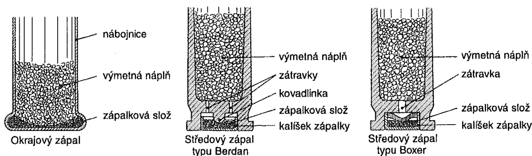
Obr. 7 Porovnání okrajového zápalu se středovým zápalem typu Beran a Boxer [3]
