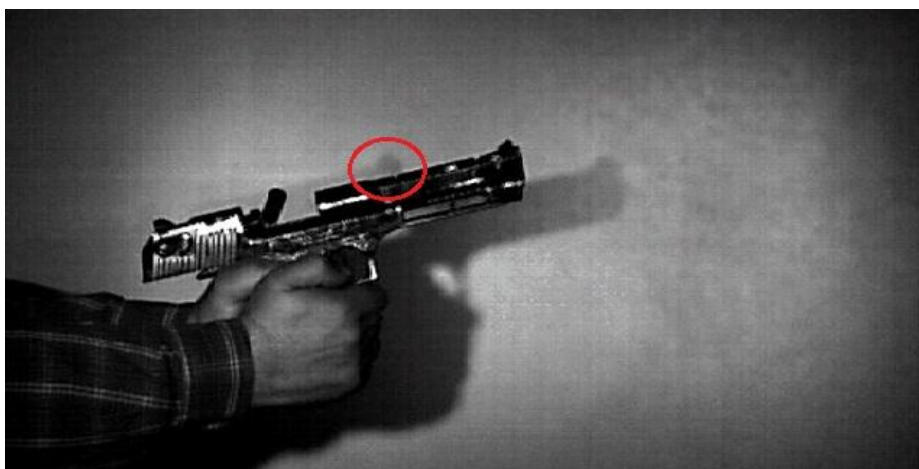
Obr. 22 Zasnvětlený záznam střelby v okamžiku vyhození prázdné nábojnice
