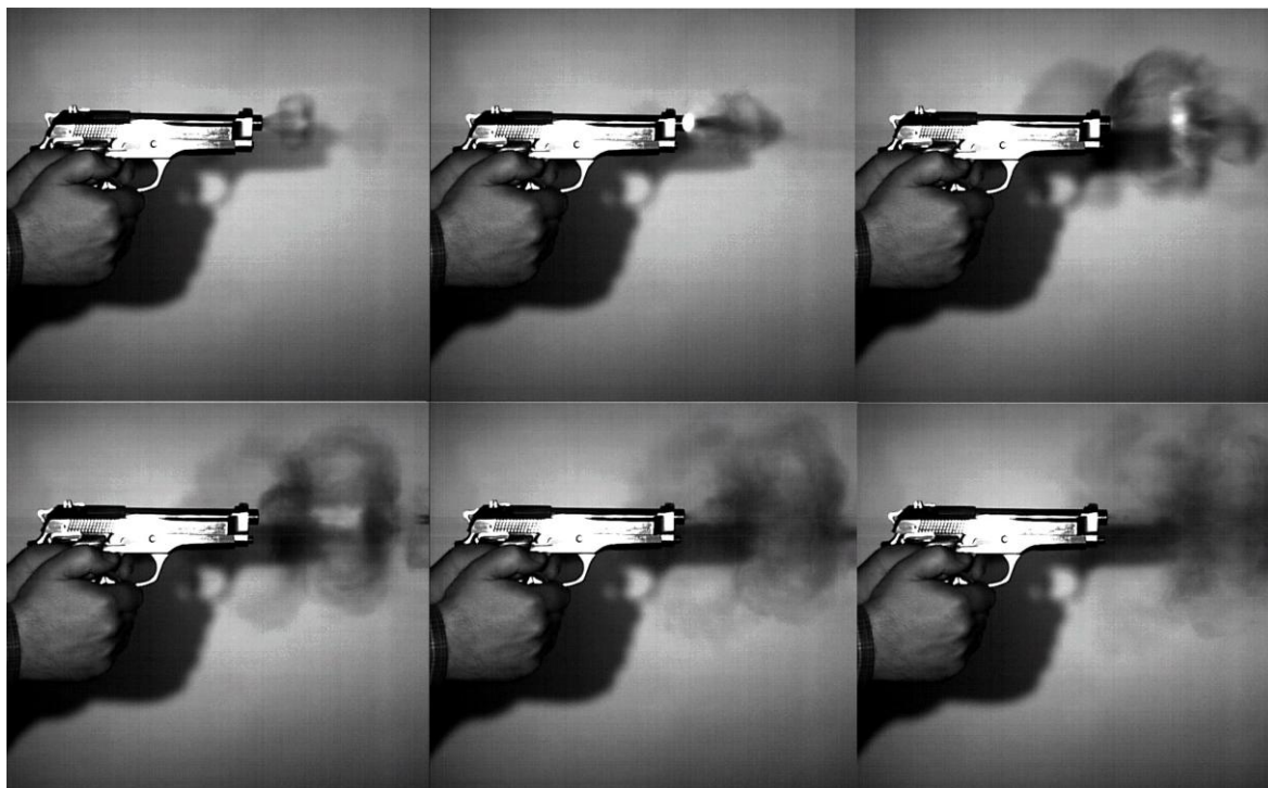
Obr. 19 Zachycení výstřelu pistole Beretta 92 Billenium
