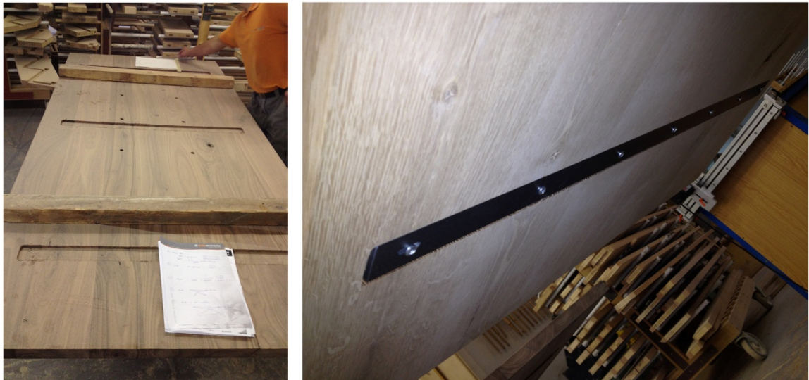
Obr. 30. Detail zpevnění stolové desky
