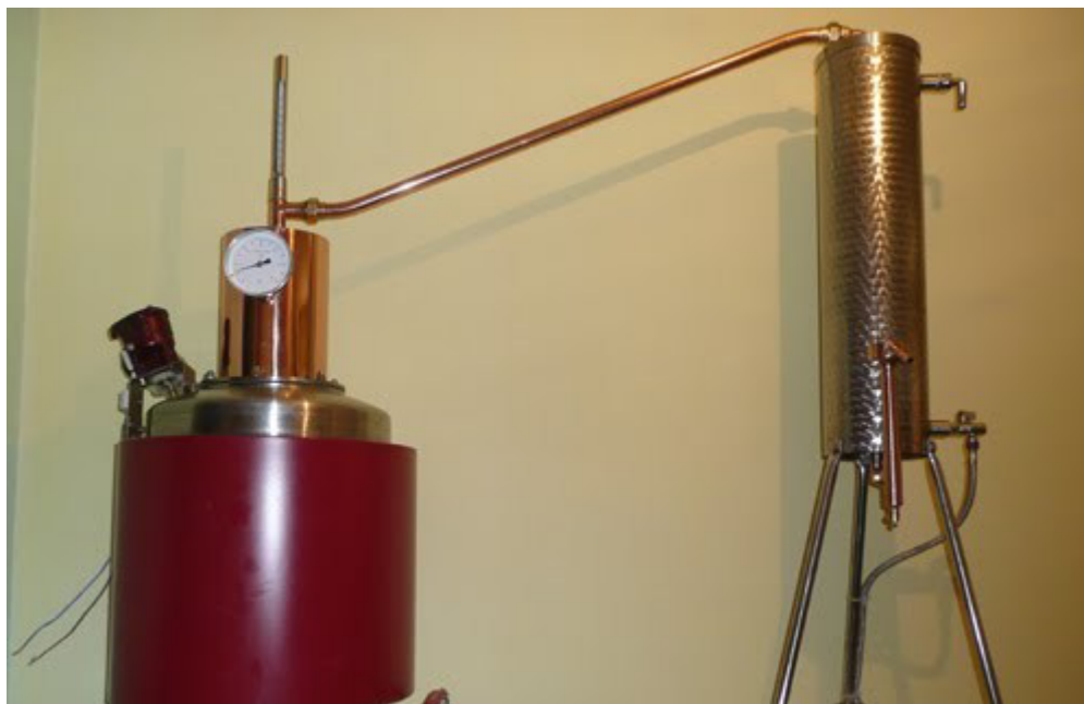
Obr. 10. Destilační kotel, klobouk, teplotní čidlo, přestupní trubka a chladič.
