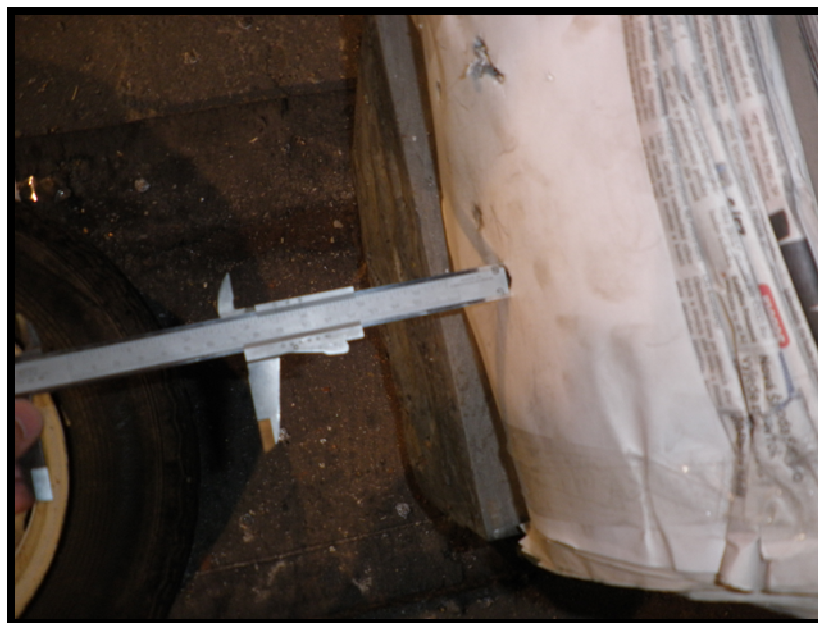
Obr. č. 19: Měření hloubky zástřelu v záchytovém materiálu
