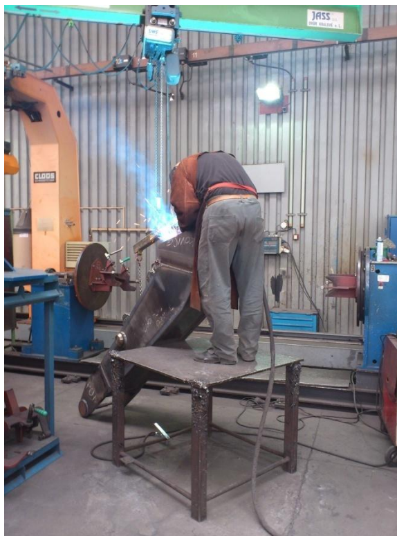
Obr. 50. Neergonomická poloha operátora při svařování (vlastní zpracování)
