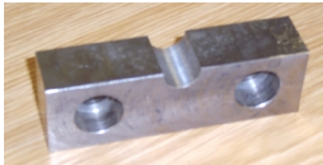
Obr. 22. Bočnice s půlkruhovou drážkou pro umístění jádra
