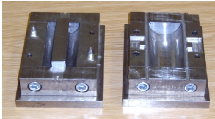
Obr. 28. Spodní a horní část lisovací formy
