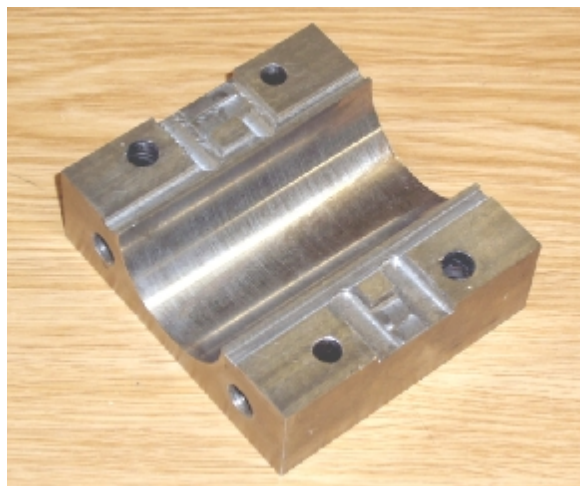
Obr. 18. Tvarová deska s válcovou dutinou
