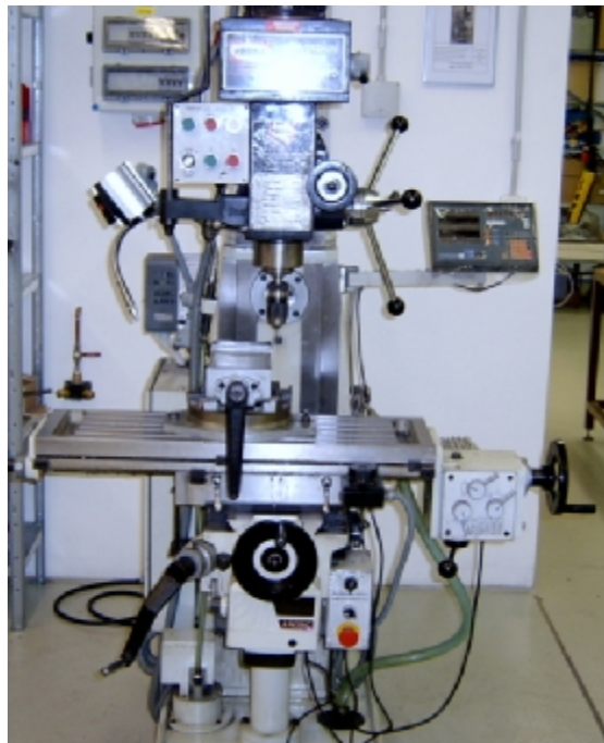
Obr. 14. Univerzální frézka FHV – 50 PD
