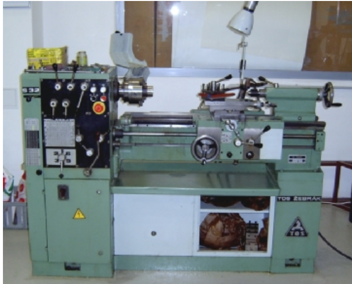
Obr. 15. Soustruh univerzální hrotový TOS zebrák – S32
