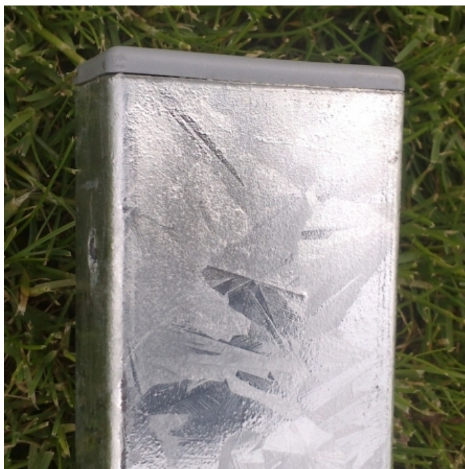
Obr. 48 Povrchová úprava žárového zinkování
