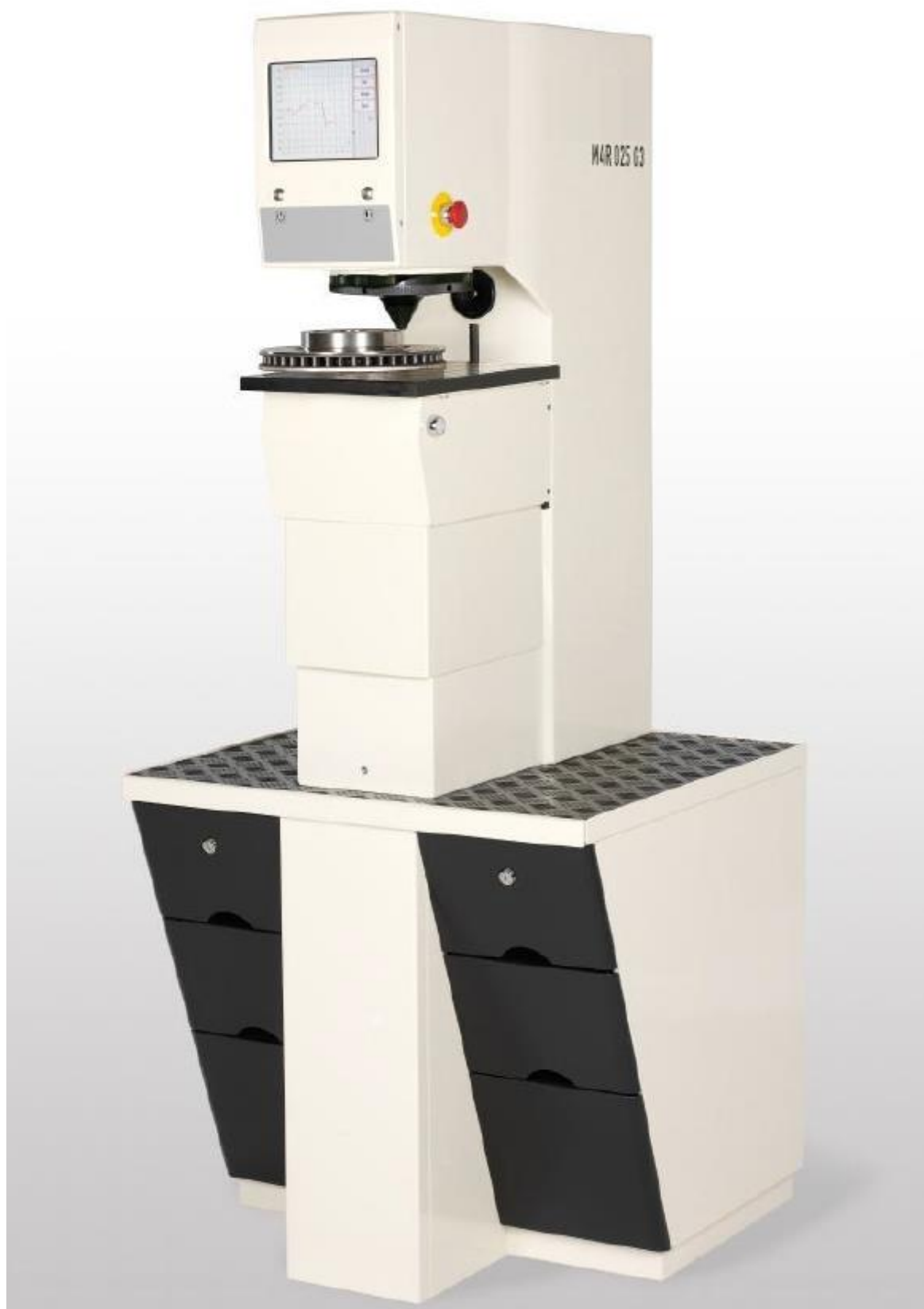
Obr. 9 Přístroj Struers DuraJet pro měření tvrdosti dle Rockwella [8]
