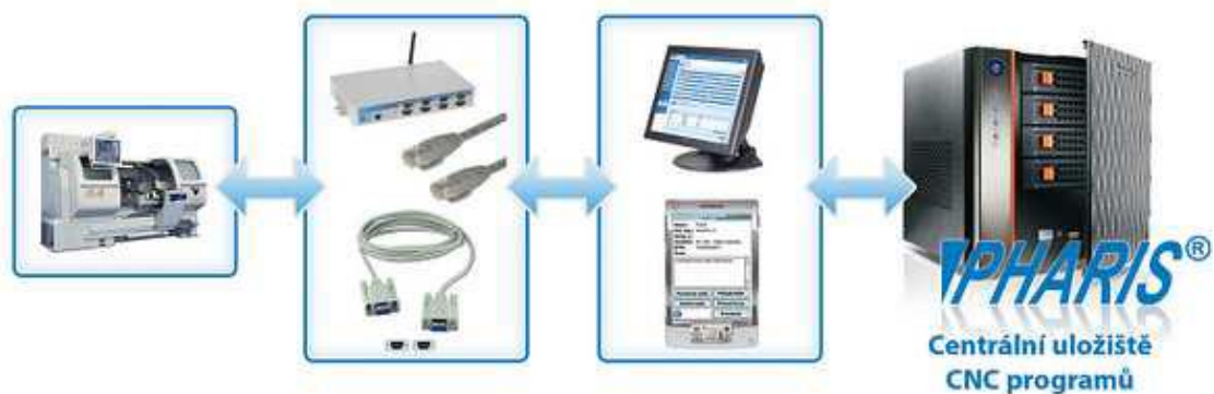
Obr. 8. DNC řízení – Přímé číslicové řízení [5]
