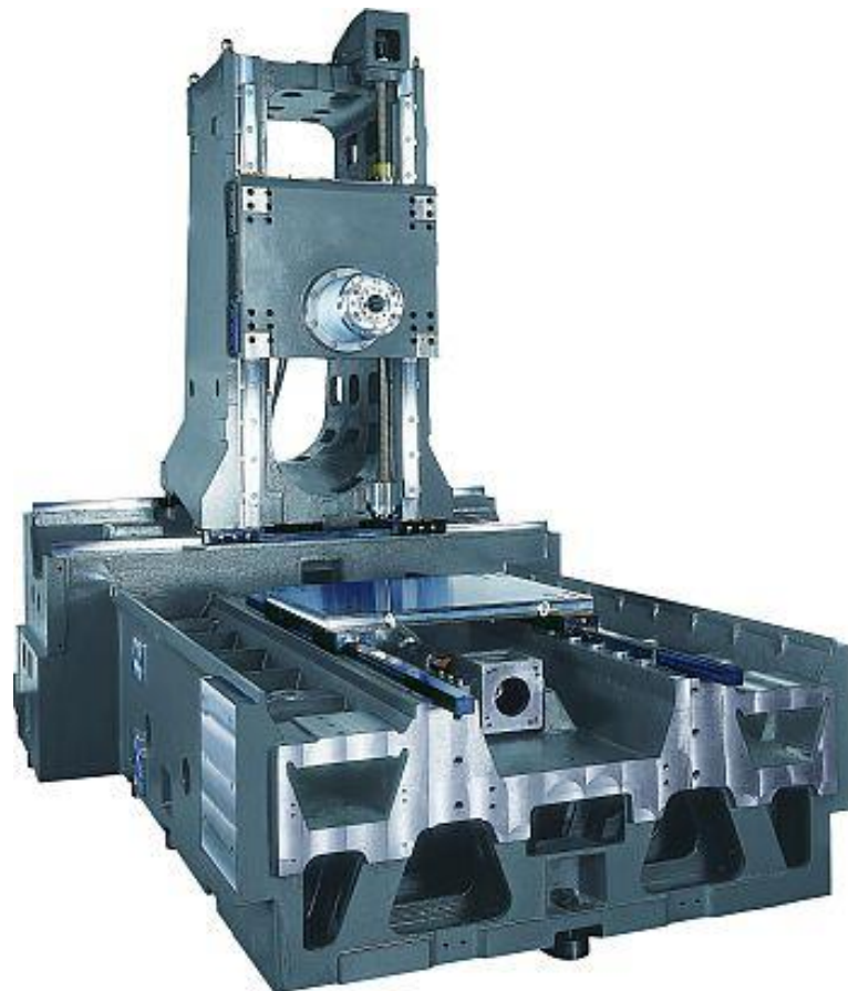
Obr. 9. Příklad litinového rámu CNC stroje [3]
