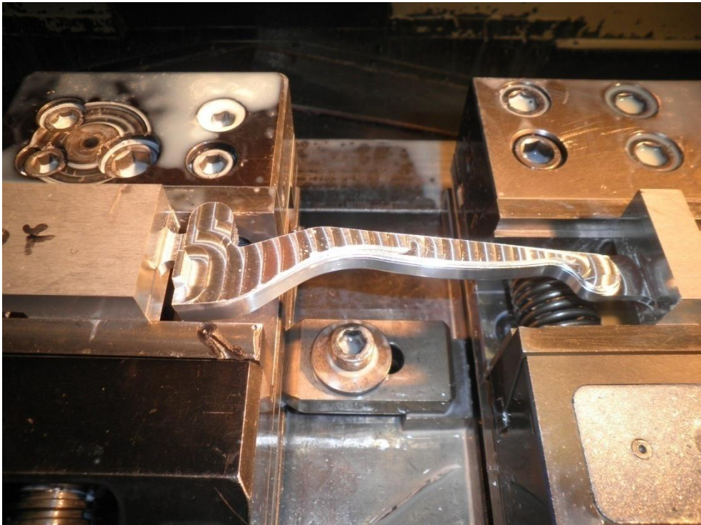
Obr. 45. Obrobek po hrubování ve druhém upnutí
