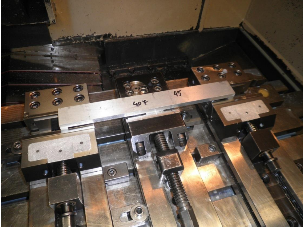
Obr. 44. Upnutý obrobek, připraven pro obrábění ve druhém upnutí
