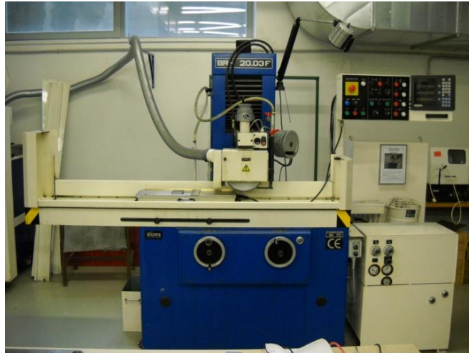
Obr. 26 Rovinná horizontální bruska BRH 20.03
