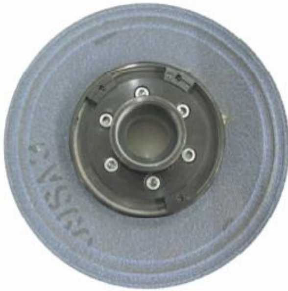
Obr. 27 Brousící kotouč s upínací přírubou s vyvažovacími tělísky
