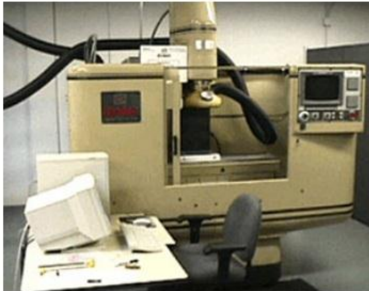
Obr. 12. Destruktivní skener RE 1000. [15]
