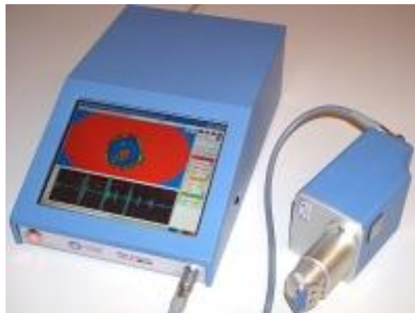
Obr. 11. Ultrazvukový skener Mini Scanner. [13]
