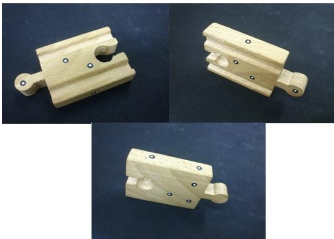
Obr. 29. Kolejnička – nalepení reflexních bodů
