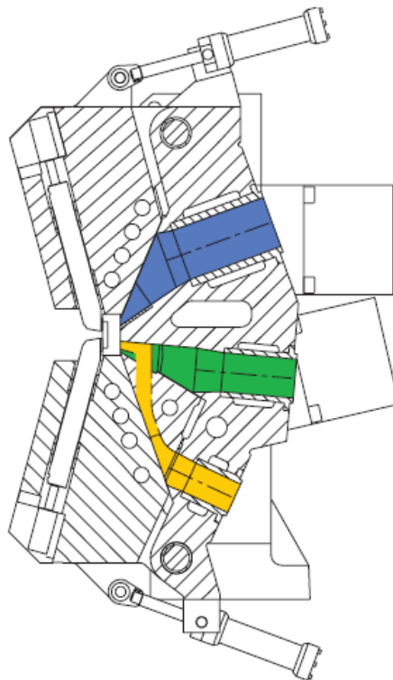
Obrázek 2: Řez sdruženou trojnásobnou vytlačovací "kladivovou" hlavou s barevným vyznačením tokových kanálů
