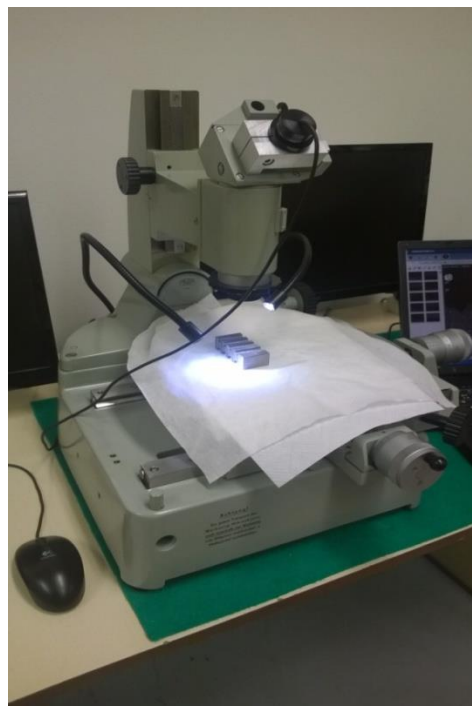
Obr. 74. Zkoumání profilu závitů pomocí mikroskopu.
