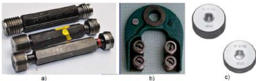
Obr. 49. Závitové kalibry (a) válečkové kalibry, b) třmenový kalibr, c) kalibrační kroužky.)
