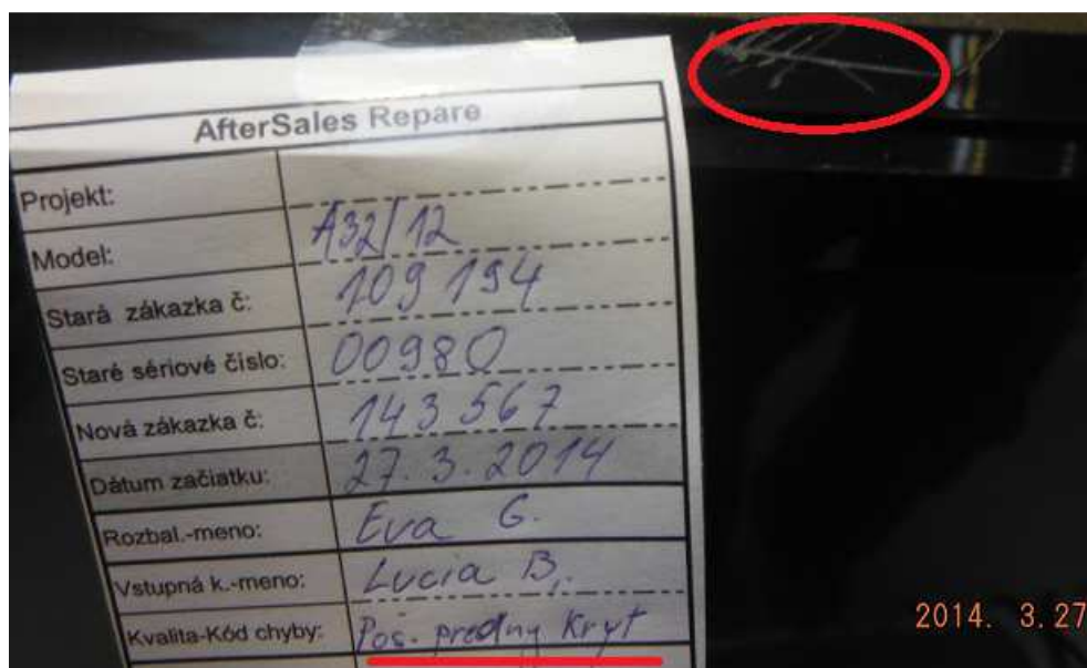
Obr. č. 15 TV s vypísaným sprievodným lístkom a poškriabaným predným krytom
