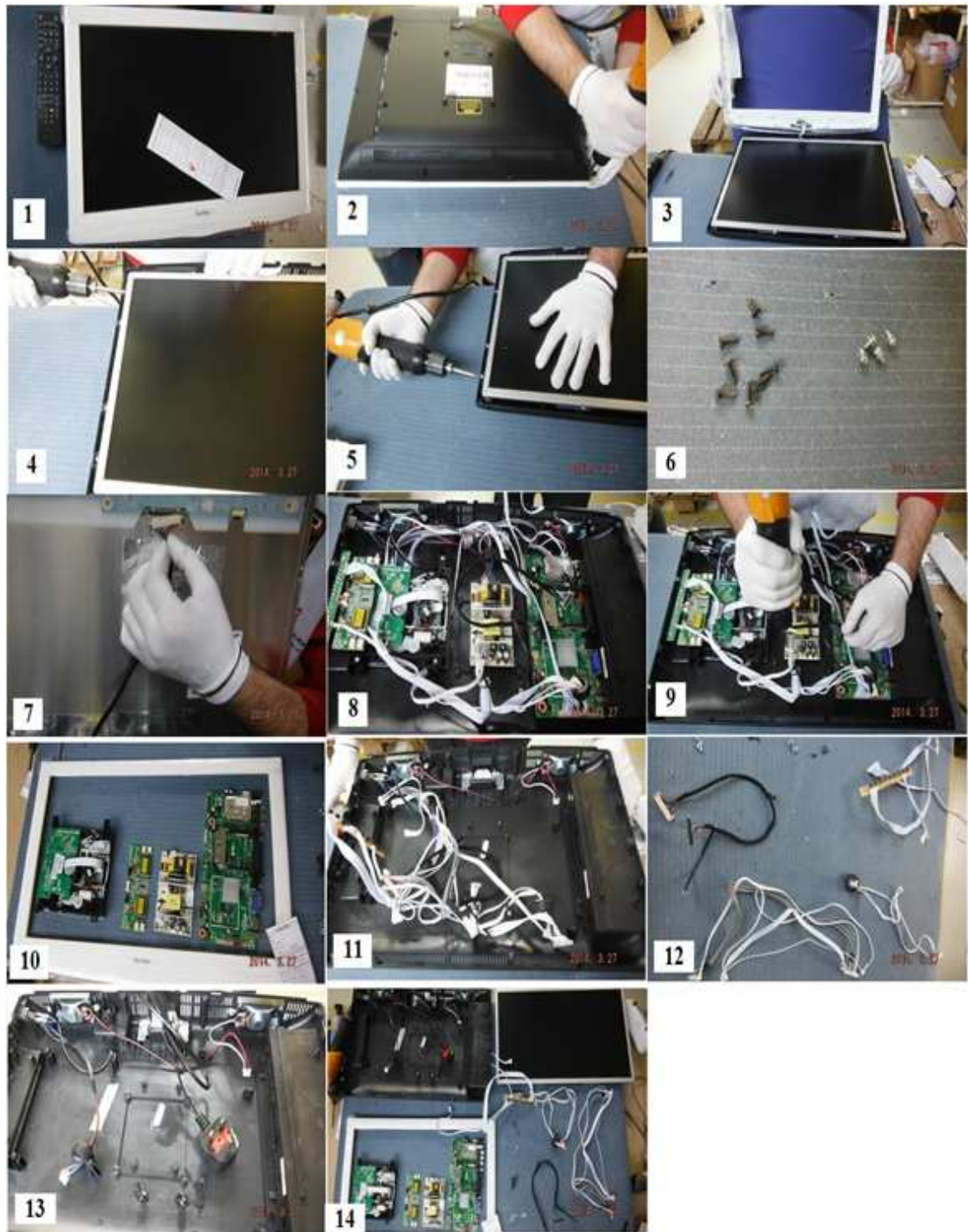
Obr. č. 22 Postup rozoberania – demontovania TV prijímača
