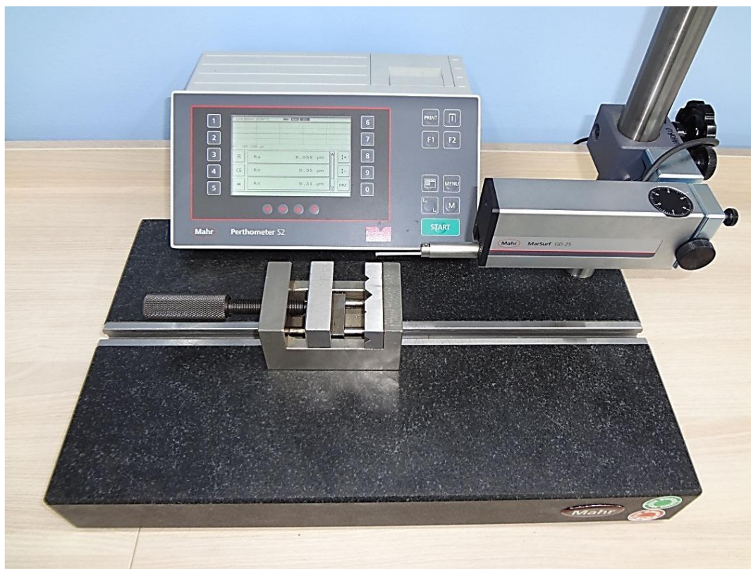
Obr. 17. Profilometr MAHR Perthometer S2.
