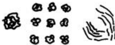
Obr. 4. Nadmolekulární struktura amorfnních plastů [12]
