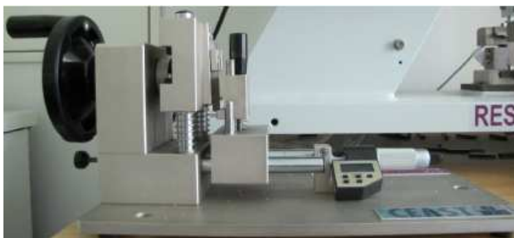
Obr. 57 Příklad na výrobu vrubů
