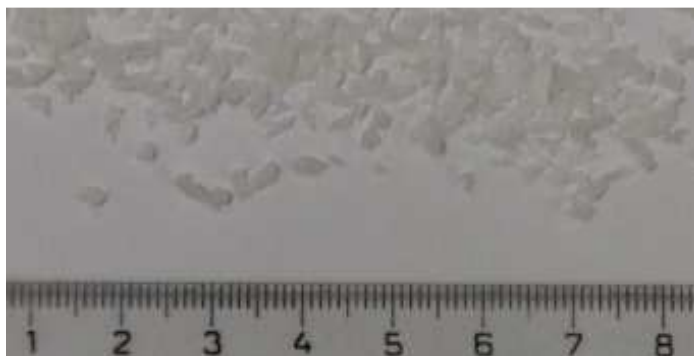
Obr. 43 Velikosti částic 1 – 2 mm
