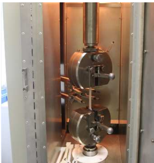
Obr. 46 Upnutí v temperační komoře
