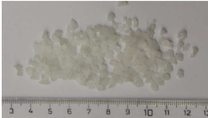
Obr. 41 Velikosti částic 3 – 4 mm
