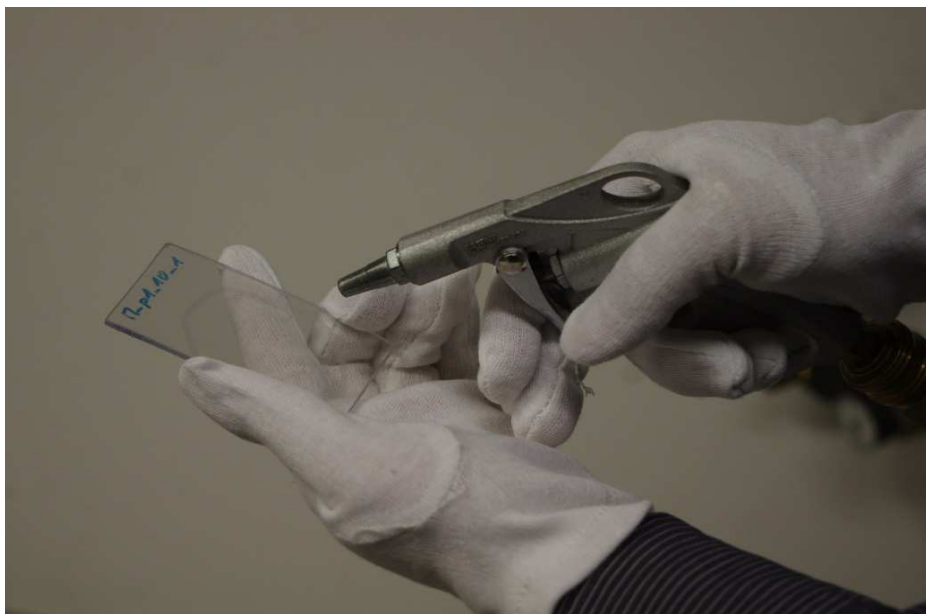
Obr. 16: Očištění vzorku tlakovým vzduchem.
