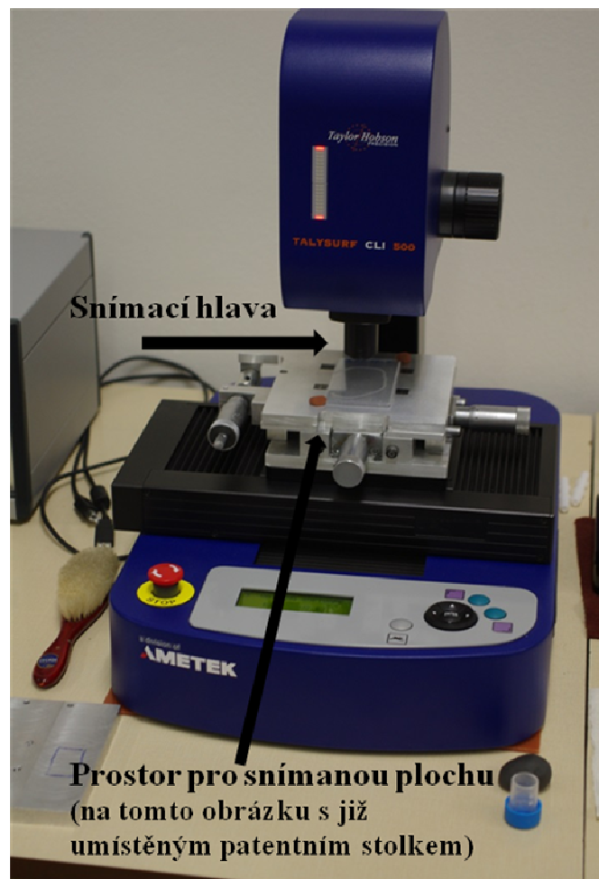
Obr. 18: Patentní stolek se vzorkem umístěný na přístroji TALYSURF CLI 500.
