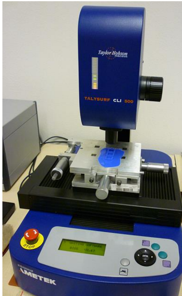
Obrázek 22: Vlastní měření otisku přístrojem Taylor Hobson CLI 500
