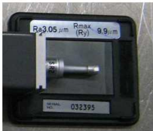
Obrázek 52: Kalibrace SJ – 301 pomocí etalonu č . 323995
