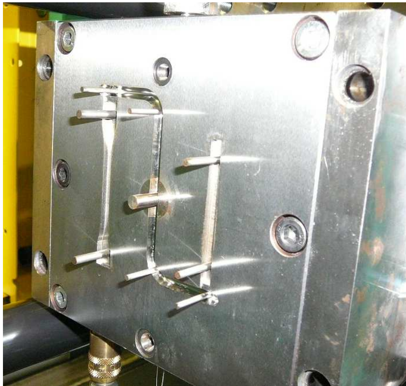
Obr. 21. Dutina vstřikovací formy na normovaná tělesa pro tahovou zkoušku.
