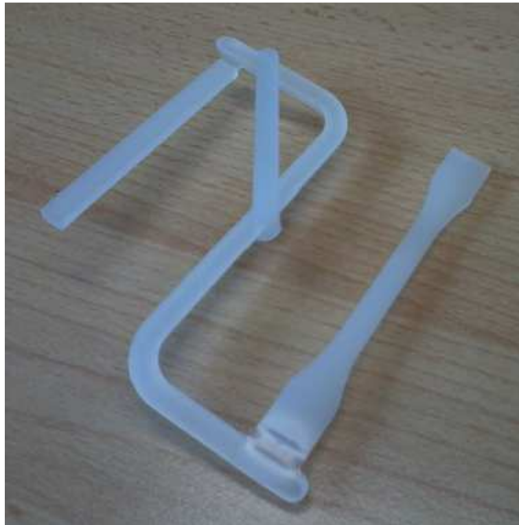
Obr. 20. Vystříknutá zkušební tělesa pro rázovou houževnatost.
