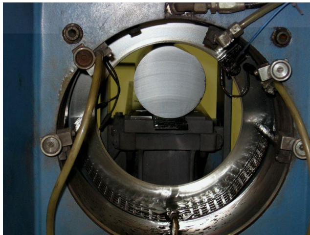
Obrázek 2 – Kruhový kotouč určený k odřezání plátek z ingotu. [6]
