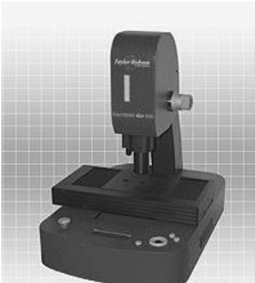
Obrázek 75 – Použitý přístroj, pro charakterizaci povrchového profilu Talysurf CLI 500.[49]
