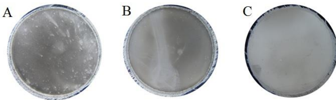
Obrázek 58 – Náhledy na vyleptané vzorky zaznamenané digitálním fotoaparát-tem po čase; A - 35 min; B - 45 min; C - 55 min. Průměr obrázku 45 mm.
