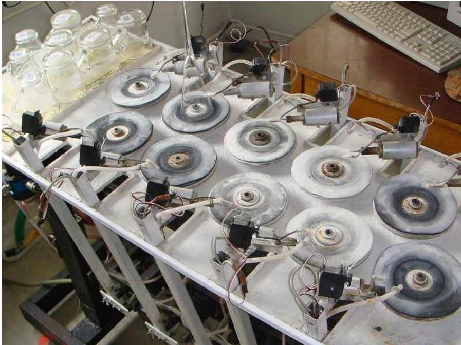
Obr. 19 Gravírovací stroj bez krytovania a bez bezpečnostného farebného označenia (vlastné spracovanie)
