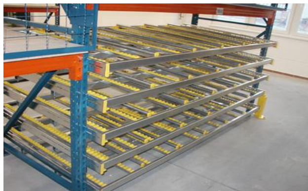
Obrázok 5 Častý typ spádového regálu ( Lambert, 2000, s. 309)
