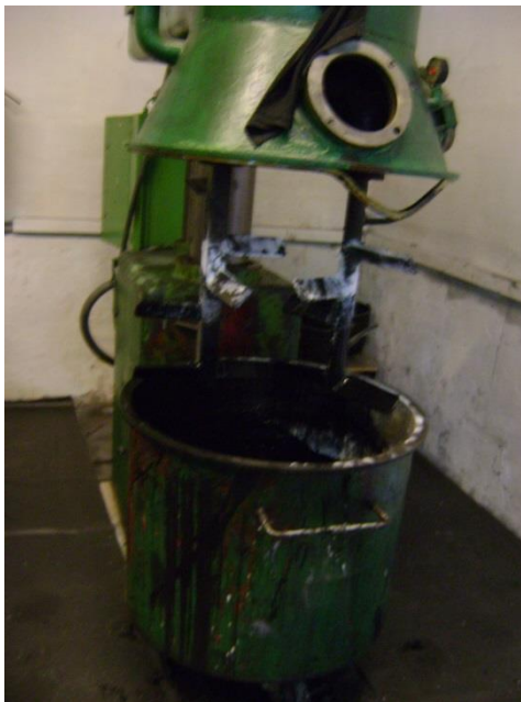
Obrázek 17: Planetová míchačka s disolverem (VI. zprac.)
